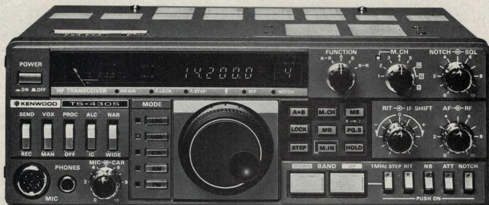
Todas las modalidades AM-CW-SSB y FM opcional. Emisión todas las bandas de 10 a 160 metros WARC y RECEPCION CONTINUA DE 150 Khz a 30 Mhz. El rango dinámico es excepcional. Dispone de doble VFO, 8 memorias, escaner de memorias, escaner de banda, desplazamiento de F.I. Filtro Notch, supresor de ruidos, silenciador y procesador de voz.
