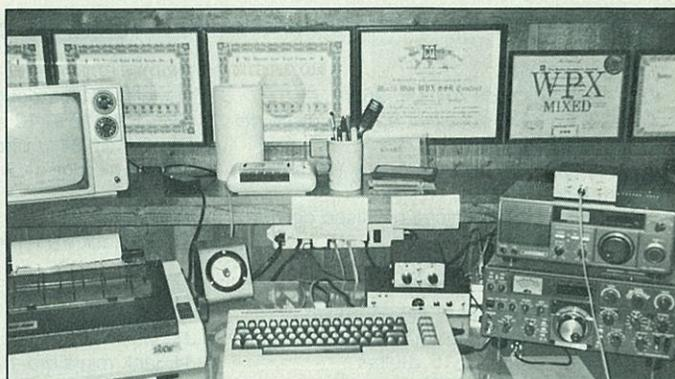
*Estación completa del autor para recepción de RTTY. Incluye el VIC-20, monitor de vídeo, impresora Gemini 10X, receptor R600, transceptor TS-530S y el demodulador de construcción propia para RTTY con filtro activo de audio.*
