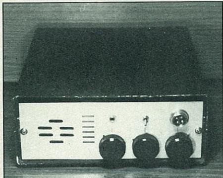
Figura 26. Aspecto del transceptor básico de BLU. Pueden apreciarse su sencillez mecánica. El equipo presenta un desafío a incluirle mejoras como «S-meter», dial digital, CAG, etc. Incorporando pocos extras y una batería de níquel-cadmio podría ser idóneo para transportar en mochila y usar en expediciones montaÑeras.
