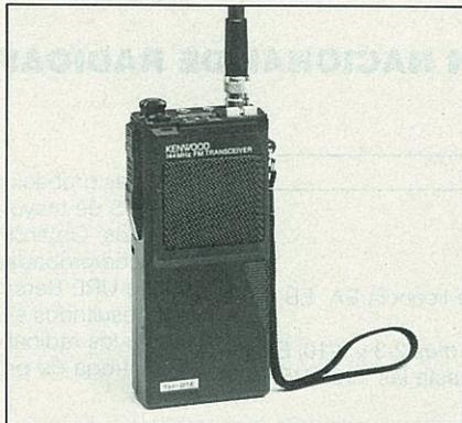
MHz. Modalidad: F3 (F3E). Alimentación: 7,2 V c.c. (estándar), 5,8 a 10 V c.c. (margen de funcionamiento). Peso: 260 g aproximadamente (con pilas).
