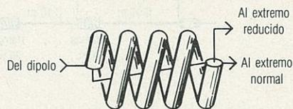
Figura 8. Trampa que utiliza cable coaxial.
