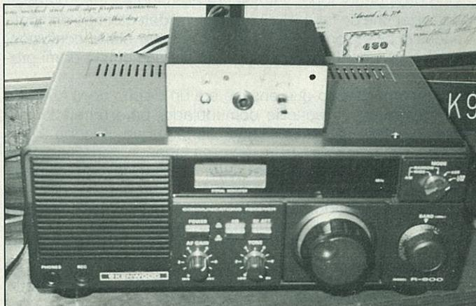
Demodulador para recepción de CW, RTTY y ASCII situado encima del receptor R600 de cobertura general.
