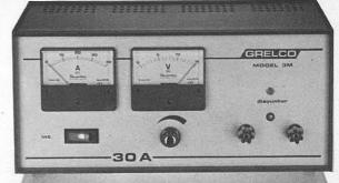
la gama mas completa 3-5-7-12-20-30-50 amperios intensidad nominal permanente opcional con instrumentos salida 13 V regulable de 11 V a 15 V rizado y ruido 20mV a plena carga
