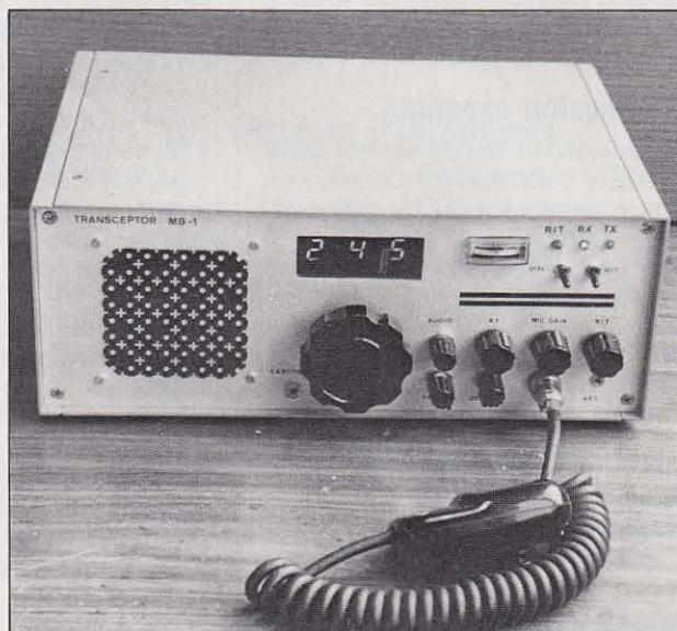
Figura 1. Aspecto del transceptor acabado. Se ha incluido un indicador digital de frecuencia.
