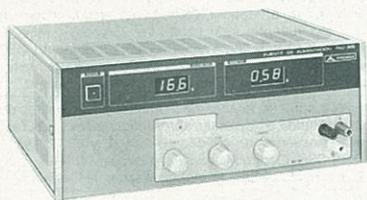
El control de la tensión y de la corriente de salida se lleva a cabo por medio de los mandos situados en el panel frontal. Un mando fino de tensión permite ajustar con toda precisión la tensión de salida requerida.
