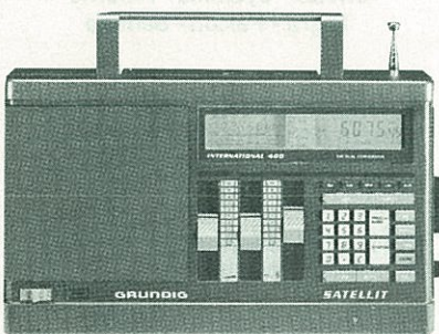
Receptor portátil Grundig Satellit 400 international con cuatro bandas (SW 1,6-30,0 MHz/AM/FM/LW), sintonía a cristal de cuarzo con PLL, doble superheterodino, sección SSB/BFO...
