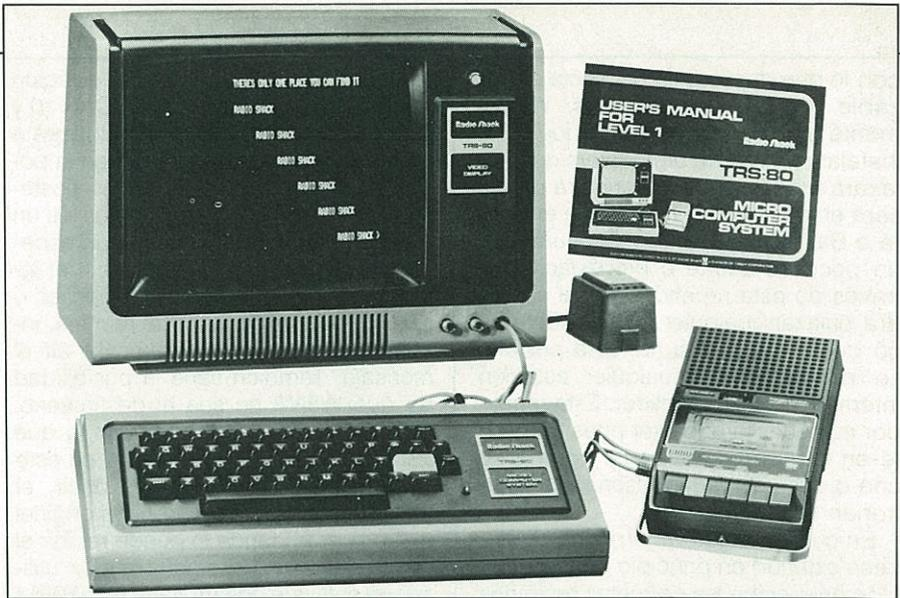
Existen unos programas en disco flexible que convierten al Radio Shack modelo I (mostrado en la foto), III y IV en el terminal de control de radiopaquetes.
