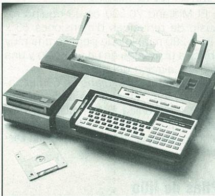
Por primera vez se incorpora a los ordenadores de bolsillo la comunicación a través de fibra óptica con una velocidad de transmisión de hasta 38,4 kbit/s. También puede recibir señales de tipo analógico.
