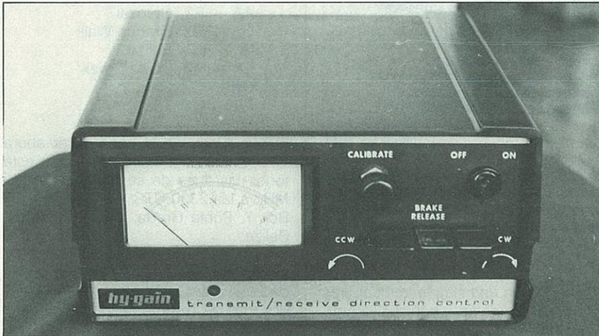
La unidad de control se halla en el interior de una elegante caja de metal y plástico. El centro de la escala del instrumento corresponde al NORTE pero puede invertirse la escala para que dicha lectura corresponda al SUR.
