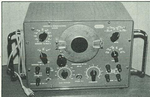
Generador de audio y de RF marca LME (escala baja) modulador de FM 100 Hz a 30 kHz y 150 kHz a 20 MHz. Alimentación 110/125/220 V ca. Profundidad de modulación: barrido de 0 a  $\pm$  50 kHz. Peso 9 kg. Con manuales y accesorios completos.
