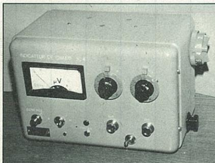
Indicador de campo IC4 Gammax. Con salida de audio a «casco». Escala 0 a 100  $\mu$ V. Utiliza tres pilas de 4,5 V. Escala UHF canales 21 a 69. Escala VHF canal 1 a 12. Con esquemas e instrucciones en francés. Peso aproximado 3,6 kg.
