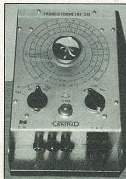
Transistometre 391, marca Central. Para la medida de factor beta o ganancia de transistores NPN y PNP entre 8 y 400, así mismo para medida de  $I_{ce0}$  de 0 a 15 mA. Utiliza una pila de 4,5 V y su peso es de 1,2 kg.
