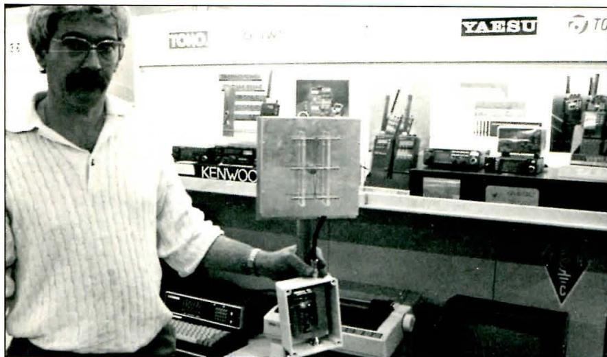
Luis, EA3YX, en su QTH de trabajo, muestra la colineal acoplada directamente al filtro digital y amplificador, con la que se consiguió el contacto TVA en 2,3 GHz.
