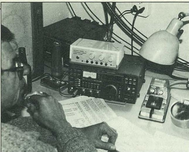
Ed, HB9RM, en el puesto de operación. Un IC-1271 junto con un filtro Datong constituye el «corazón del sistema».
