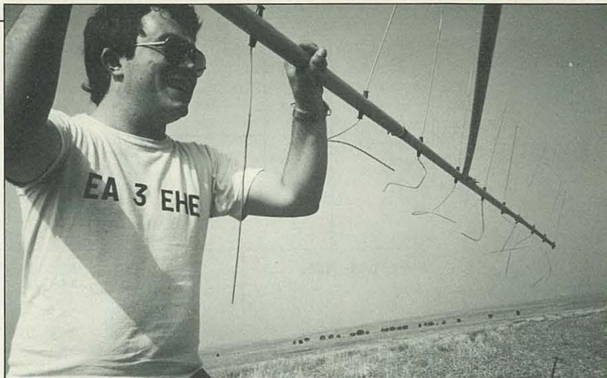
Long Yagi con directores ondulados. No se trata de nuevas tecnologías para ganar más decibelios o direccionalidad extra. Es, simplemente, el resultado de una caída «en picado» desde 8 m de altura al fallar un viento y desplomarse el mástil que soportaba la antena. HI
