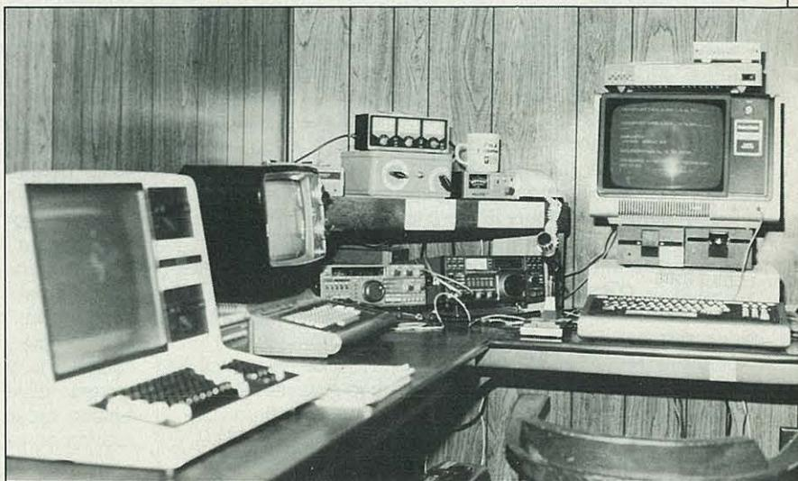
Estación de KR3T superpreparada para las comunicaciones digitales. Por lo general KR3T dispone de dos estaciones de RTTY: la primera con un TRS-80 Color Computer e Interface Kantronics II y la segunda con un TRS-80 Model IV e interface Kantronics KAM.
