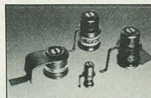
dad y resultan extremadamente estables. Pueden adquirirse con dieléctrico de vidrio con capacidad máxima de 60 pF; con dieléctrico de aire hasta 14 pF y con dieléctrico de zafiro hasta 8 pF. Los respectivos Q tienen valores
