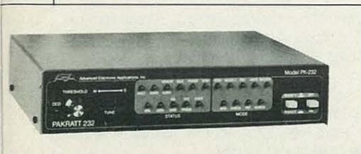
100 baudios), ASCII RTTY a 110, 150 y 300 baudios, facsímil, Morse (5 a 99 ppm), etc. Trabaja con alimentación de 12 a 16 Vcc, mide 280 x 210 x 64 mm y pesa 1,36 kg.
