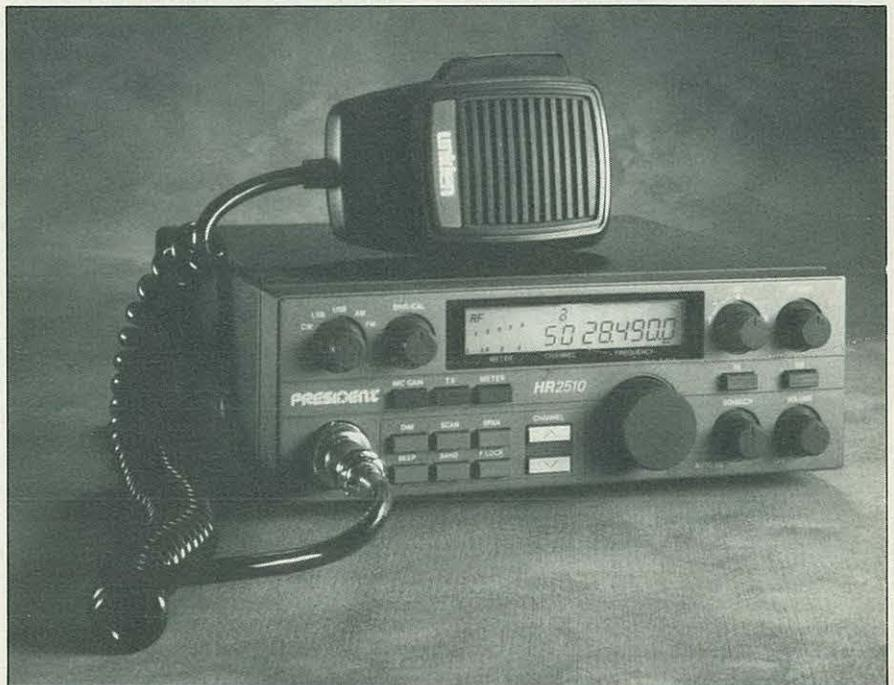
El modelo *Uniden HR-2510* es un transceptor compacto para la banda de 10 metros con un receptor sensible y un transmisor de 25 W de potencia de salida.
