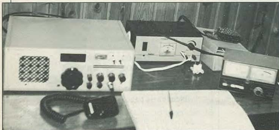
Aspecto de la estación transceptora utilizada: un equipo monobanda de construcción casera a partir de un semikit, fuente de alimentación y medidor de ROE. ¡5 W en antena!
