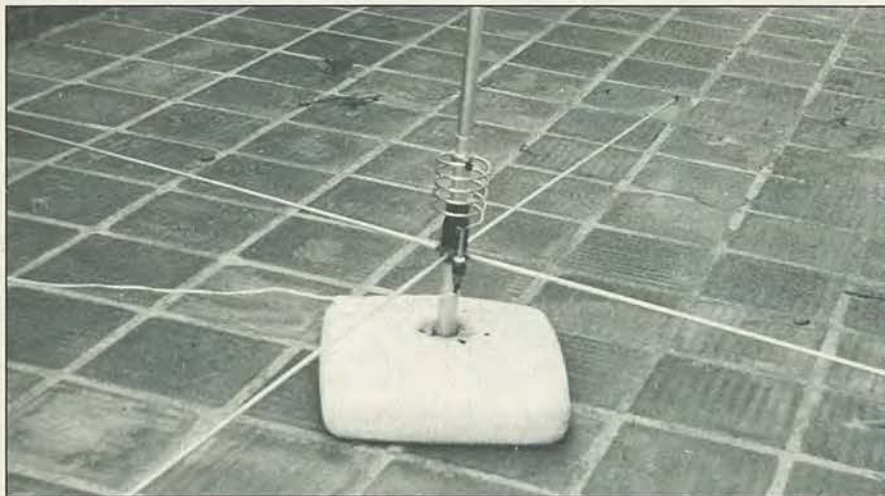
La antena Tornado de 5/8 para 27 MHz sustentada por un «soportaparaesoles». Pueden apreciarse los radiales de más de un metro de longitud y la bobina de carga.
