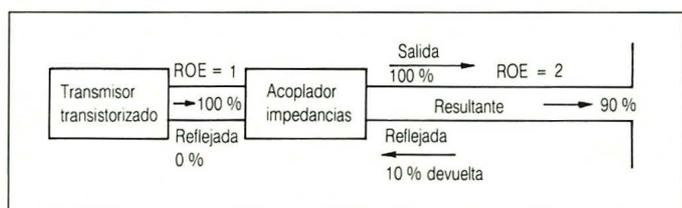
Figura 10. Aparentemente si  $ROE = 2$ , es devuelta al transmisor un 10 % de la energía enviada, pero acaba siendo transmitida el 100 % gracias al acoplador.
