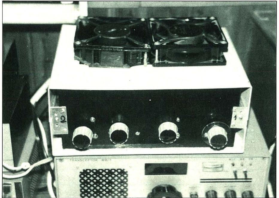
Aspecto del lineal «que no vale nada» construido con materiales reciclados. Alimentado a 1.000 V y con diodos zener en los cátodos entregaría unos 150 W efectivos. Con cuatro válvulas EL519 en paralelo conseguiríamos cerca del kilovatio PEP.
