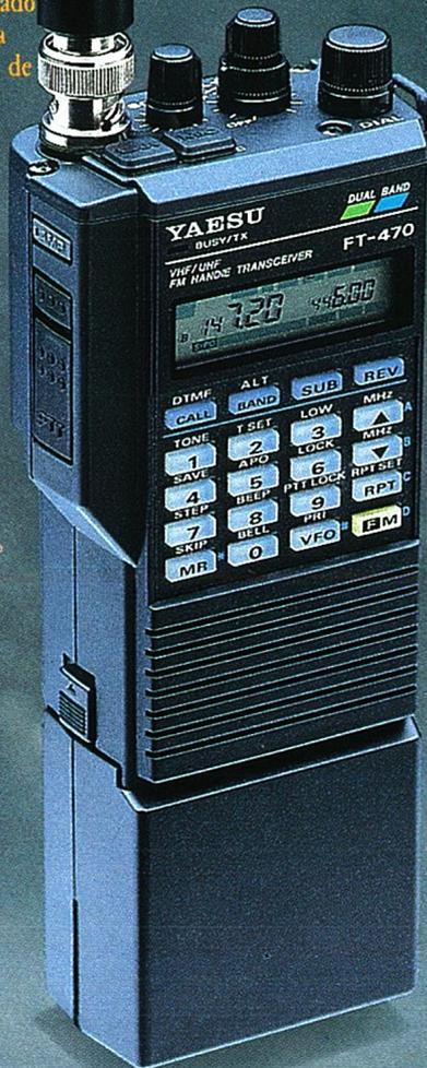
**Potencia salida:** Con batería FNB-17: 2,5 W (FT-411E); 2 W (FT-811); 1 W (FT-911). Con batería FNB-12S: 5 W (FT-411E y FT-811); 1 W (FT-911).
