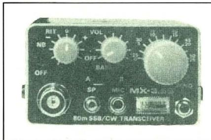
Estos portátiles, entre los que igualmente se incluye la versión para 7 MHz, llevan BLU además de la CW. La caja metálica mide 66 x 39 x 142 mm y contiene circuito limitador de ruidos, atenuador, RIT, medidor de señal, altavoz, micrófono interior y manipulador igualmente interior, si bien llevan conectores para estos tres últimos elementos exteriores. La unidad para 80 metros puede sintonizar 25 kHz. Se alimenta con seis pilas del tipo AA para una salida de 2 W.
