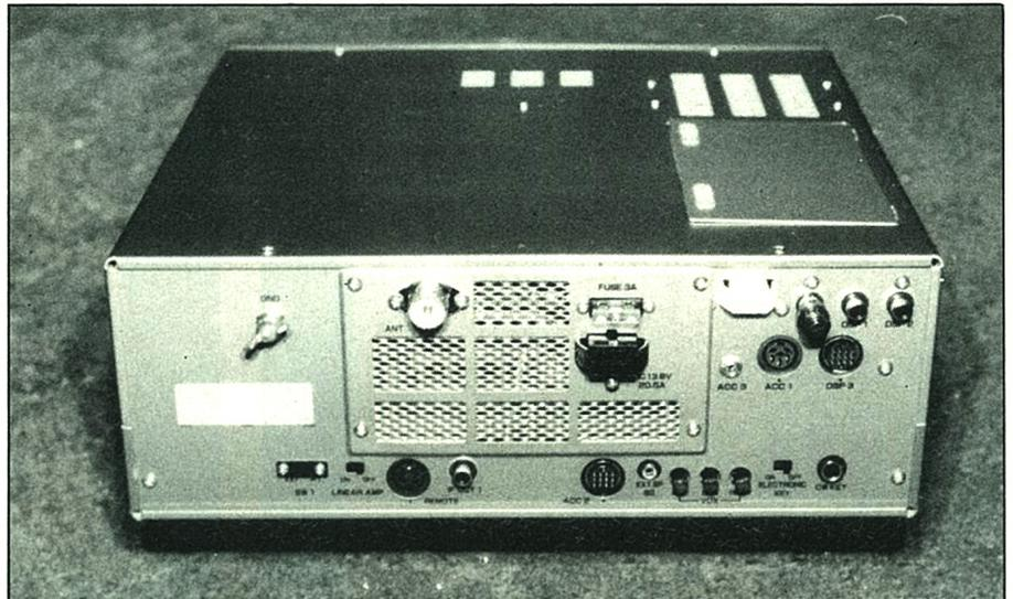
*Vista de la parte posterior. Convenientemente distribuidas, acomoda un gran número de conexiones exteriores, desde las necesarias para el control de un amplificador lineal hasta cuanto concierne al uso de un TNC. El pequeño e interesante portafusibles tipo coche rotulado «FUSE 3A» me tuvo intrigado algún tiempo. Se trata de un fusible de protección independiente, destinado a la conexión de un acoplador automático de antena remoto (AT-300) que se puede gobernar desde el TS-850S.*
