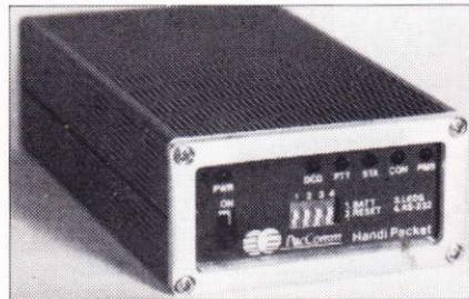
trata de un completo TNC que sólo mide 33x65x106 mm con batería incluida y que va encerrado en caja metálica protectora. Ofrece «Open Squelch» digital DCD, sistema de mensajes personales «PacComm» con espacio para 15 mensajes y funciona de 8 a 10 horas seguidas con cada carga de las baterías. Se incluyen todos los cables y accesorios necesarios para la puesta en marcha.
