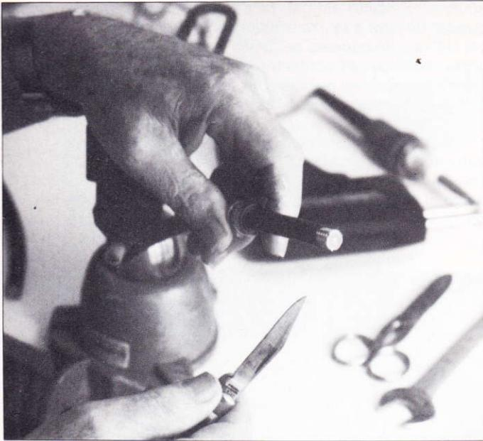
Figura 2. Retirada del aislante exterior: tras cortar el cabo al ras, deslizar el tornillo y la arandela por el extremo del cable y realizar un cuidadoso corte circular del aislante exterior a 9 mm del extremo del cable, procurando no morder la malla.
