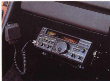
**Instalación móvil:** El diseño compacto y la incorporación del acoplador de antenas hacen del FT-890 el mejor compañero en el móvil, sobre todo con el uso del soporte opcional (kit MMB-20).
