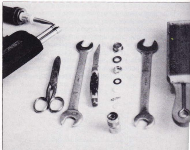
Figura 1. Herramientas para el montaje y despiece del conector tipo N. De izquierda a derecha: soldador de unos 35 W, soldador de pistola pequeño con la punta retirada, tijeras, llave fija de 5/8 de pulgada, navaja afilada, despiece del conector macho tipo N con contacto central cautivo, llave fija de 11/16 pulgadas y carda
