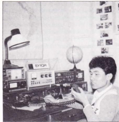
Shujian, al frente de la estación, BY1QH, operador también de BT8ØTUA. Las antenas de BY1QH son una Yagi monobanda para 20 metros, Yagi 3 el. para 10 y 15 metros. Delta Loop para 40 metros y una vertical multi-banda. Los transceptores son un TS-180S y un IC-751 A. Además de dos amplificadores lineales, un FL-2000B y un IC-2KL.
