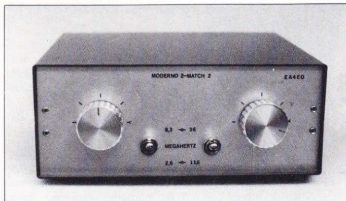
En el «Moderno Z-match-2» no se incluye el puente de ruido. A la derecha está el condensador de entrada y su conmutador y a la izquierda el tándem y el conmutador de bandas.
