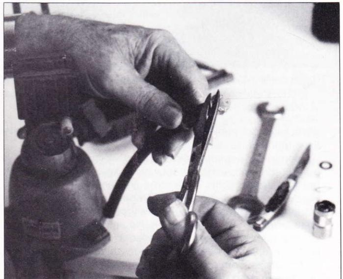
Figura 4. Recortar la malla sobrante. ¡No utilizar alicates de corte oblicuo!
