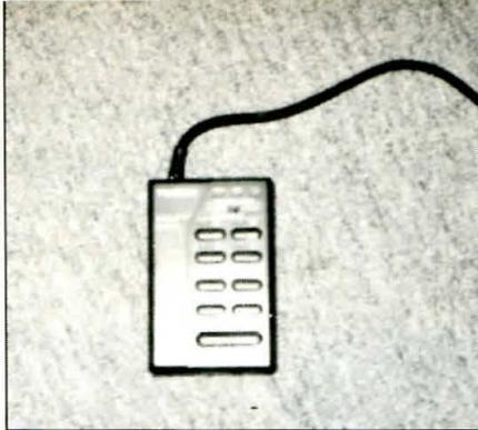
*La DVS-2 es una pequeña unidad de grabación/reproducción digital de voz de estado sólido. Acopla con el FT-1000 a través de un único cable/conector y permite la grabación de transmisiones, grabación por el micrófono del FT-1000 y reproducción de mensajes grabados.*
