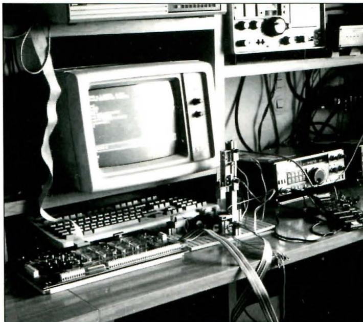
Equipo puente con una placa de robótica conectada a través del radio-paquete (RP).
