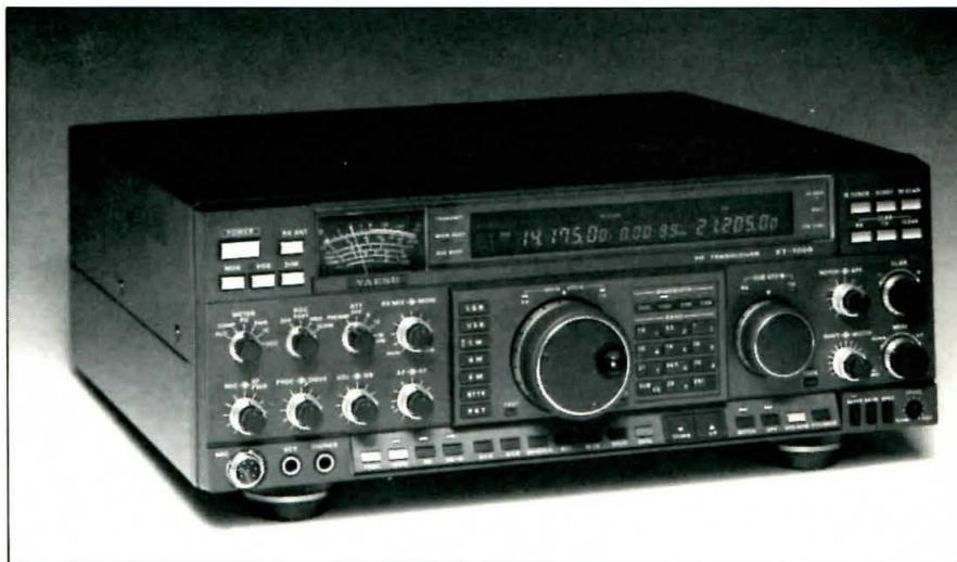
Los mandos principales de sintonización para el receptor y subreceptor destacan en el panel delantero del FT-1000. El dial digital incluye la lectura de frecuencia del receptor principal, desviación RIT/XIT, número del canal de memoria, lectura de frecuencia del subreceptor y varios indicadores pequeños.
