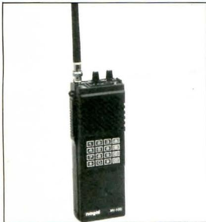
go, auricular, sujetador a cinturón, amplificador de 25 W, etc.). Tiene una potencia de salida de 3 W y tan sólo mide 165 x 65 x 35 mm. Tal vez sea una buena ocasión para los EB recién estrenados.
