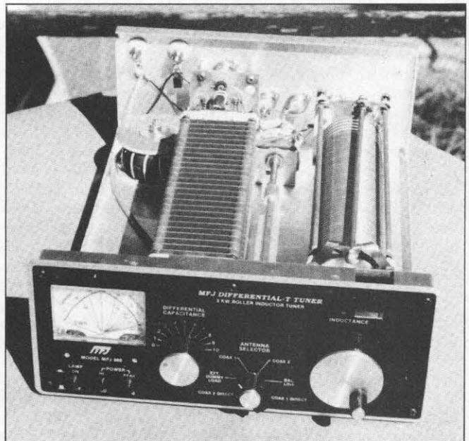
Acoplador MFJ con condensador diferencial. Preparado para la máxima potencia legal, trabaja formidablemente tanto con línea coaxial como con línea paralela.
