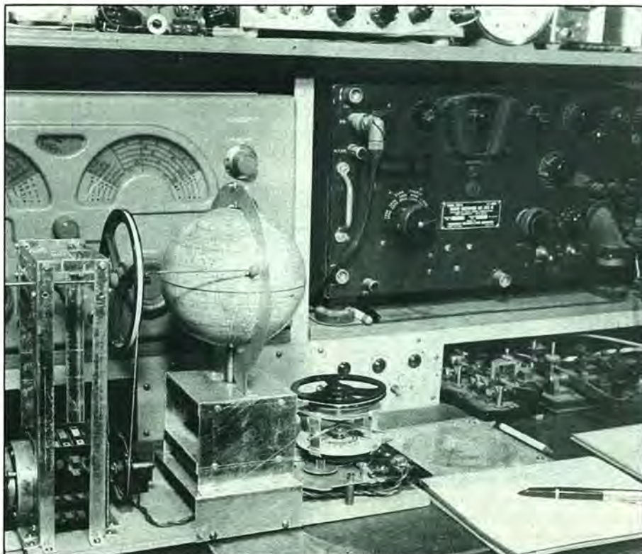
Este sistema que ideé hacia 1965, me permitía de forma automática conocer la posición del satélite sobre la esfera terrestre.
