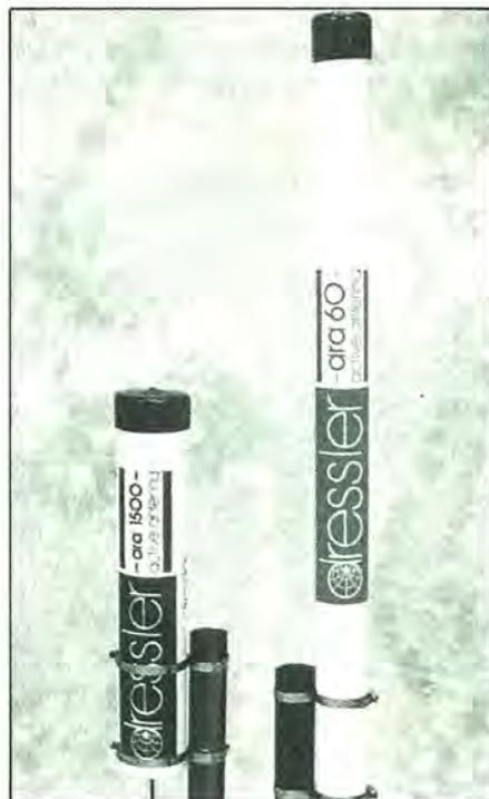
El modelo Ara 60 para HF, de 95 cm de longitud para las frecuencias comprendidas entre 30 kHz y 60 MHz, lleva control automático de ganancia y ofrece bajo ruido, encerrando un circuito amplificador de RF en clase A. Se alimenta a 220 V. Estructura tubular hermética.
