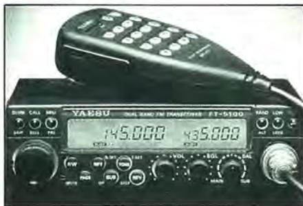
Además de las funciones propias de los móviles *Yaesu*, el FT-5100 presentado al mercado por *Astec*, posee un doble receptor capacitado para que operen dos canales en la misma banda. Una serie de 92 memorias independientes completan un sistema
