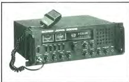
e incorpora medidor de ROE, frecuencímetro, indicador de funciones de modulación, bip, eco, etc. Se alimenta con 220 Vca 50 Hz y tiene un consumo de 90 W. Receptor de doble conversión con FI de 10,695 MHz y 455 kHz. Lleva clarificador (RIT) de  $\pm$  5 kHz y un altavoz interior dinámico de 8  $\Omega$ .
