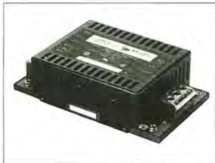
en la modalidad AC-DC como en DC-DC. Su modelo VI-FBE6-CUX, por ejemplo, tiene entrada a 115/230 V con salida de CC hasta 250 W (otros modelos de entrada monofásica hasta 700 W y de entrada trifásica hasta 5.000 W de salida). Incorporan filtros EMI/RFI, protección transitorios, limitación corriente de apertura y sistemas de control. *Vicor* dispone de un amplio catálogo de fuentes de alimentación que cubre prácticamente todas las necesidades de fuentes seguras y de garantía.
