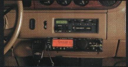
Los mandos del FT-900AT se instalan prácticamente en cualquier rincón del coche, camión o caravana. El circuito de potencia de 100 W de RF se puede ubicar en el maletero o debajo de cualquier asiento.
