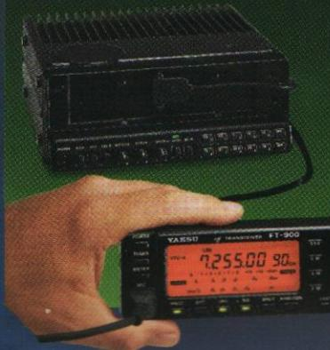
Las dimensiones del panel frontal remoto son tan sólo de 57 mm de altura, 232 mm de anchura y 32 mm de profundidad.
