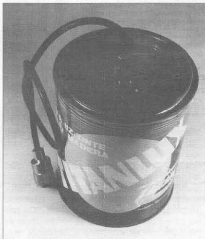
La reutilización de materiales es una de las bases de la ecología. He aquí un ejemplo ilustrativo: un bote de pintura aloja una carga artificial con capacidad para 100 W de RF.
