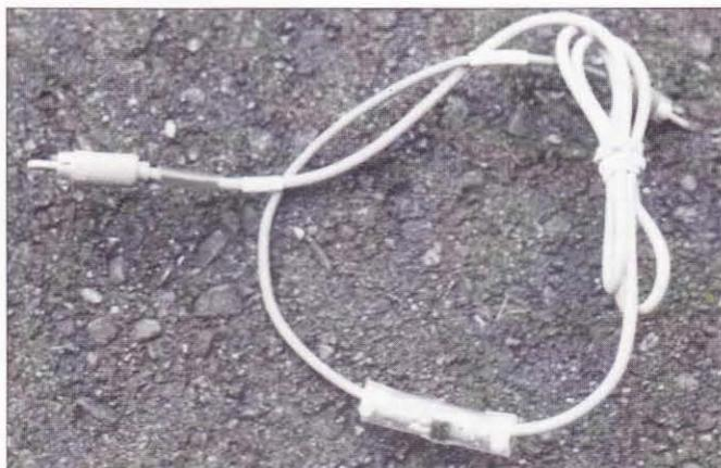
Foto 3. Cable de interfaz para el transceptor Kenwood TS-50S y equipos similares que utiliza un transistor PNP para aislamiento.
