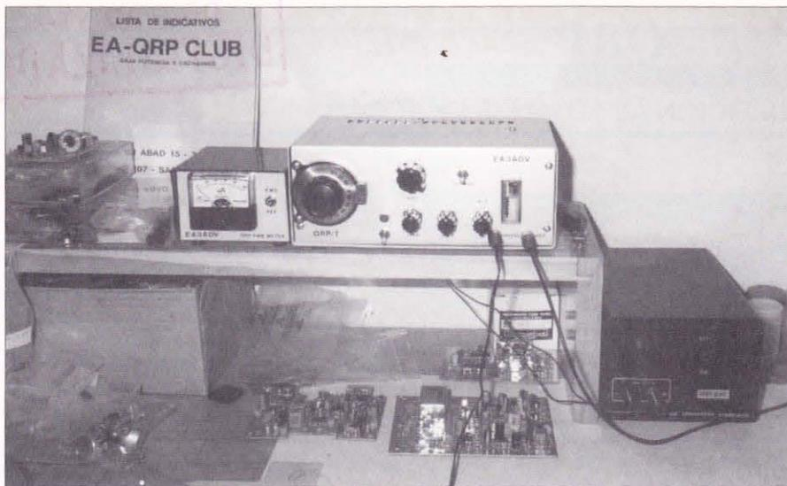
Foto 3. Transceptor para 40 metros CW, TCV/7 y a su izquierda una versión del vatímetro direccional de Stockton.
