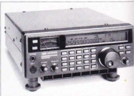
La preselección electrónica de los filtros de entrada trabaja automáticamente entre 500 kHz y 999,999 MHz, proporcionando una real mejora en un receptor que puede explorar a una cadencia de 50 canales por segundo. El control por microprocesador con 1.000 memorias, su decodificador DTMF/CTCSS y sus facilidades de autoprogramación y control remoto hacen de este equipo un ejemplar excepcional.
