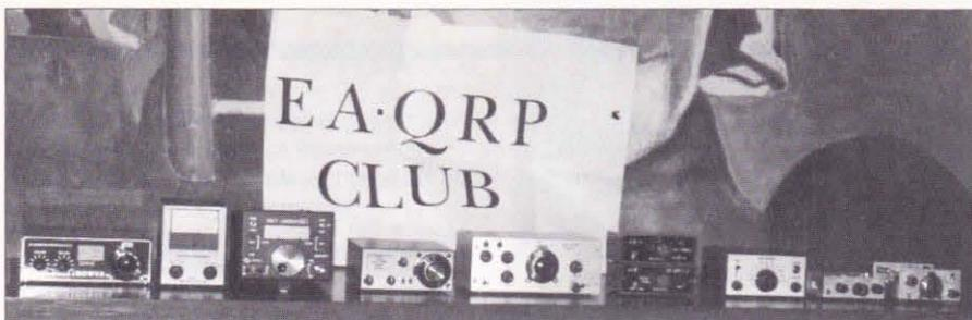
Foto 5. Pequeña exposición con diversos equipos. De izquierda a derecha receptor de conversión directa de Howes, vatímetro direccional de OHR, transceptor toda banda QRP Plus, dos transceptores de EA5BVK, equipo para 20 metros de EA3FHC, Sprint II de OHR, Poti-Poti 40 y Malta-20.
