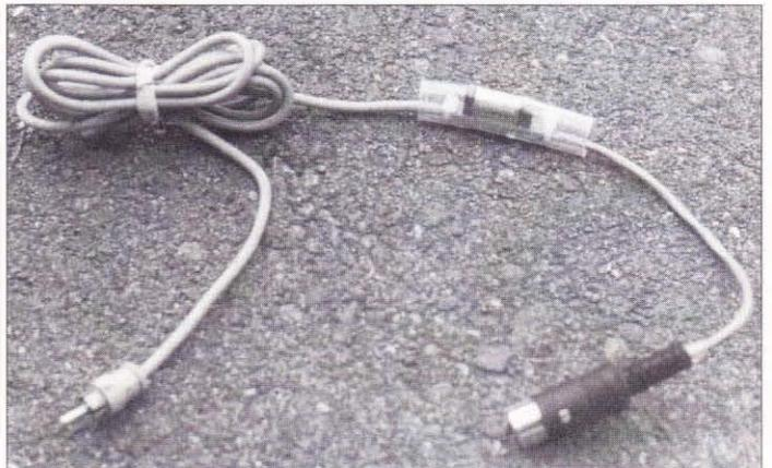
Foto 2. Un cable de interfaz para muchos transceptores Icom que utiliza un relé «reed» para aislamiento.
