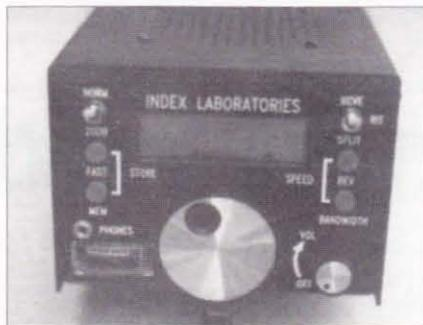
con banda pasante variable de 100 Hz a 2400 Hz, manipulador iámbico CW incorporado, 20 memorias, *split*, RIT, etc. Dice el fabricante que es un equipo QRP de mitad de tamaño, mitad de precio (594 \$ en USA) y una décima parte de consumo. Sus dimensiones son de 140 mm de anchura, 102 mm de altura y 153 mm de profundidad. En recepción consume tan sólo 140 mA a 12 V de batería. Potencia de salida de 5 W.
