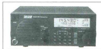
trabajo en 2 metros en FM. El equipo funciona como dos radios; la primera permite el trabajo como transceptor en el margen de 142 a 150 MHz, mientras el segundo equipo opera como receptor banda en los márgenes entre 136-174 y 420-470 MHz. El equipo incluye ranuras internas para acomodar tarjetas de radiopaquete a 1.200/9.600 bps, recepción de satélite, Fax y datos. Una tarjeta TNC opcional y un demodulador en su interior ayudan a reducir la presencia de cables externos.
