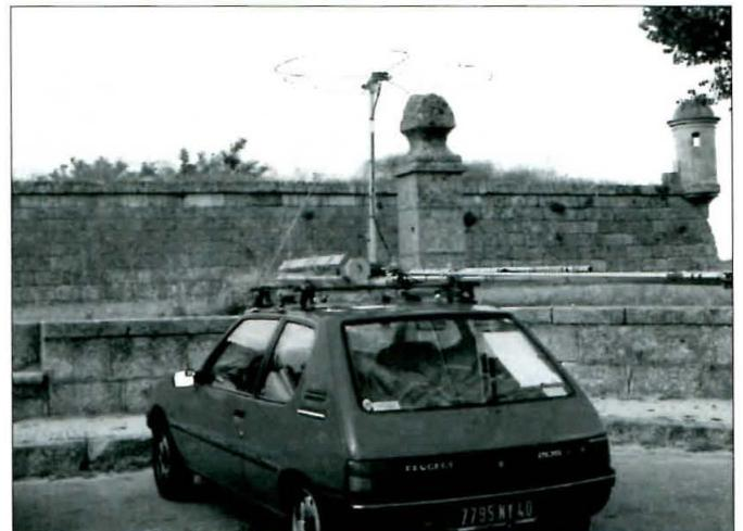
La antena «big wheel» instalada sobre el móvil con la que se logró QSO a 500 km en SSB.
