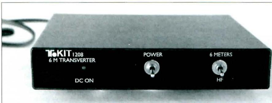
Foto A. Vista frontal del transversor para 6 metros Ten-Tec 1208.
