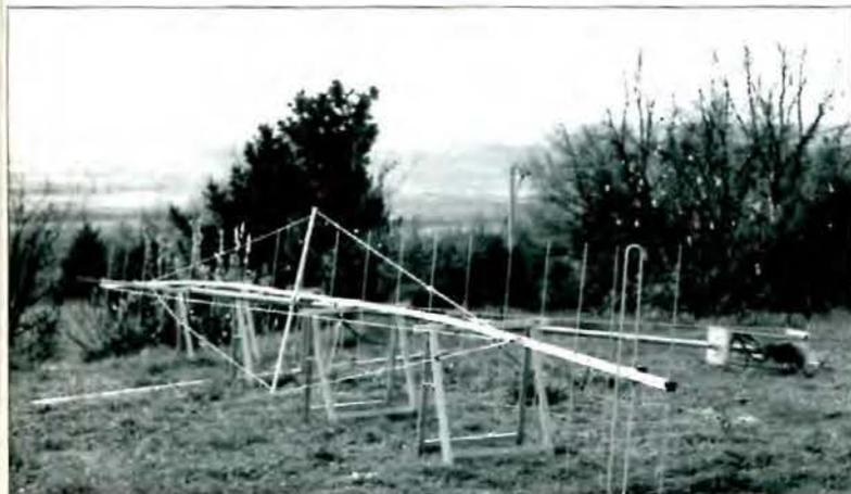
Antena «La criatura» (12,52 m) Yagi de 20 el. DJ9BC, marca «Eagle», ensamblada, completa y lista para ser izada en Casseuil, QTH de F5ADT, frente a los Pirineos, en marzo de 1998.
