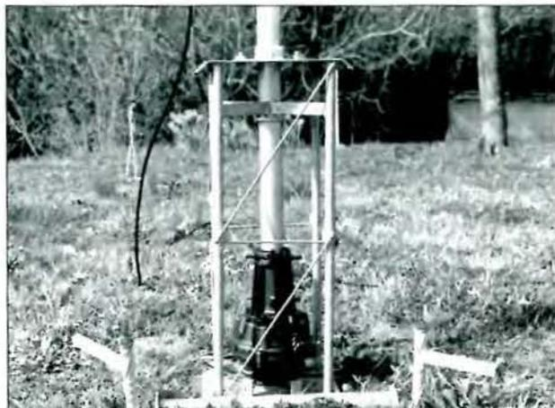
Dispositivo especial para antenas Yagi largas, que aloja el rotor de giro y permite el abatimiento del conjunto.
