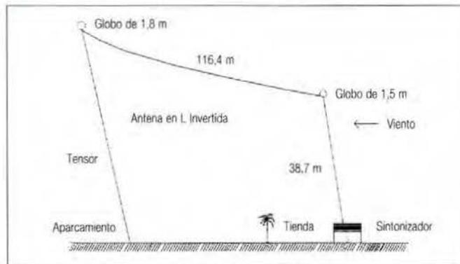
Figura 7. Disposición de la L invertida para 160 metros.
