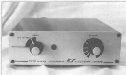
MHz. Su sensibilidad en recepción es de 0,3  $\mu$ V y la tasa de supresión de armónicos es mejor que 50 dB. La posición OFF del conmutador de funciones transfiere la antena de HF a la salida del transceptor. Su precio es de 29.232 ptas. (IVA incluido) y su distribuidor para España es GCY Comunicaciones. Tel. 973 22 15 17; fax 973 22 05 26; correo-E: [ea3gcy@iws.es](mailto:ea3gcy@iws.es).
