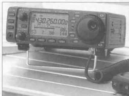
margen de cobertura, el IC-706MKIIG ofrece algunas prestaciones adicionales, como teclado iluminado, función «repetidor» automática, manipulador electrónico y QSK, filtro estrecho (opcional) para CW, FM estrecha para 10 y 2 metros, sintetizador de voz (opcional) y todo el resto de funciones de su predecesor, el IC-706MKII, cuyos accesorios son compatibles con el nuevo modelo.
