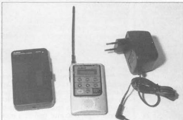
▲ Conjunto: unidad de carga, transceptor y transformador.
