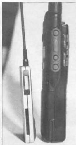
conector que trae (roscado) a cualquier otro tipo para conectar otras antenas. No es así. Los equipos portátiles se definen como tales y no es aconsejable conectarlos a antenas exteriores, como se ha podido demostrar en cientos de experiencias. Este equipo viene sin la antena, para ser puesta cuando se saca de su caja y, lo normal, es no volver a quitarla si no es para guardar en su caja todo el equipo.
