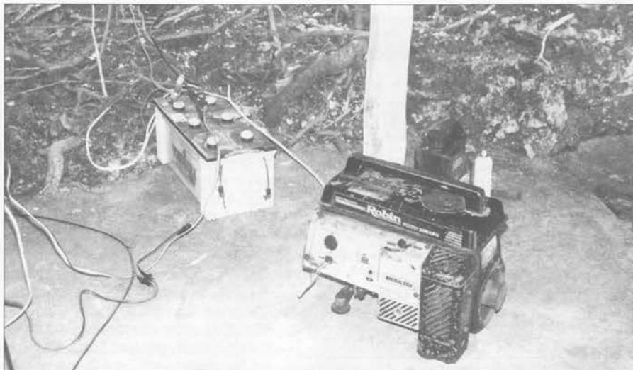
La alimentación de fortuna: una batería, un generador como cargador y paneles solares.
