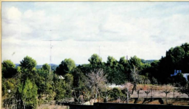
El campo de antenas de EA6IB. De izquierda a derecha: 3 el. 40 m + 5 el. 15 m; 5 el. 20 m; 5 el. 10 m.
