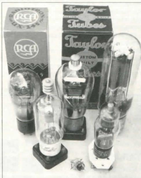
Figura 1. Iniciar la propia colección de válvulas típicas es fácil, divertida y muy reconfortante. Posteriormente se pueden utilizar las válvulas especiales de una colección bien planeada para su utilización ocasional en la reconstrucción de equipo clásico. Las válvulas aquí mostradas son una esbelta 211A, de 50 W, la famosa Taylor T-20, una RCA 245, una Western Electric 311B, una Eimac 3ST y una pequeña 956 (tipo «bellota»). Más detalles en el texto.
