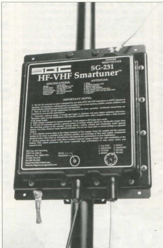
El acoplador automático de antena controlado por microprocesador SG-231 Smartuner.
