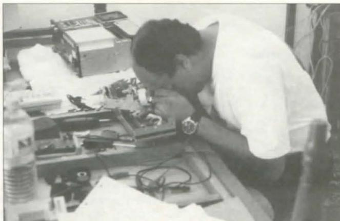
Oscar Resto, KP4RF, fue capaz de empalmar meticulosamente todas las pistas cortadas de la placa de circuito impreso del FT-1000MP averiado, utilizando una técnica de microcirugía que habría prestigiado a cualquier neurocirujano.
