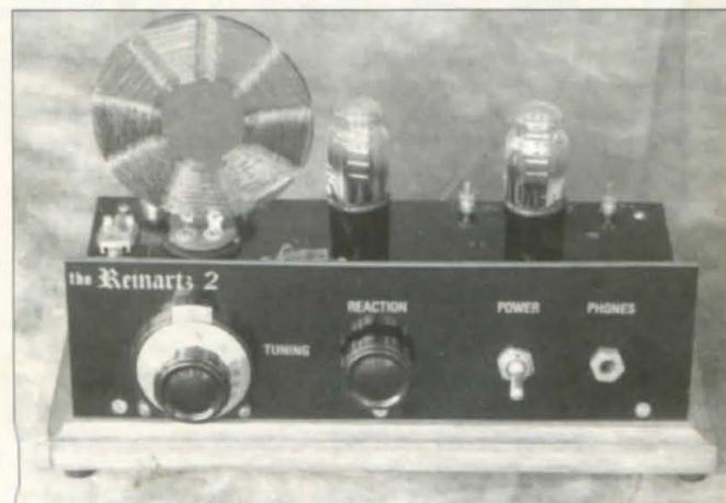
Figura 6. Deslumbrante receptor Reinartz de dos válvulas con bobina devanada en «tela de araña» construido por Robert Root, WD6DPU. El panel frontal y la estantería que sirve de chasis van sujetos entre sí con tornillos y forman un conjunto en L que se monta sobre un tablero de 2,5 cm de grueso. Los componentes situados por debajo del chasis quedan entre la estantería y el tablero base. ¿No se acelera vuestro pulso al contemplar esa bobina? (Foto WD6DPU).
