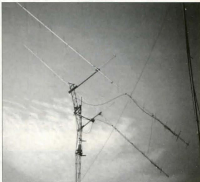
Formación de dos antenas Yagi 17 el. 10M144 con elevación de EA3TI (QTH).
