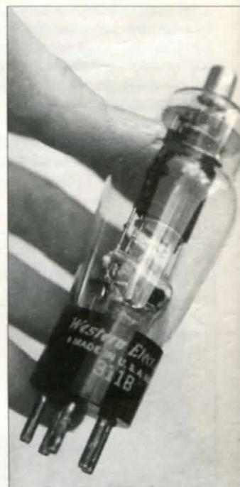
Figura 2. Primer plano de una válvula Western Electric tipo 311B. La caperuza superior es la conexión de la rejilla de mando (no la placa, como podría suponerse). La base es del viejo estilo de cinco patillas.
