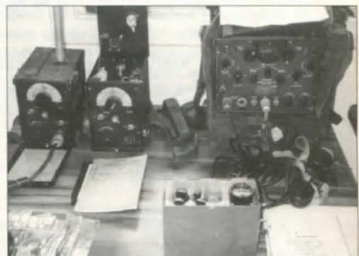
A la izquierda se ven un par de transceptores TBX-5, mientras a la derecha hay un TBY. Enfrente se aprecia un equipo japonés de campaña para el margen 30-40 MHz.
