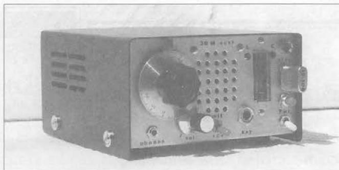
Foto 4. Vista frontal del cuidadoso trans-receptor QRP casero realizado por Stan, W3TFA. El emisor está controlado a cristal, con tono lateral y medidor de salida en el panel. El receptor es un diseño de tres integrados con sintonía a VXO y proporciona suficiente audio para excitar un altavoz montado tras el panel frontal. Se incluye un paquete de baterías, así que Stan sólo necesita conectar una antena y un manipulador para operar. El tamaño es 7,5 x 13 x 13 cm.
