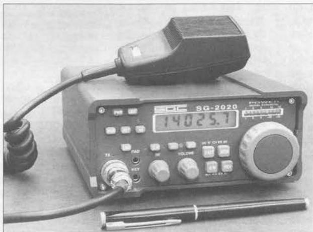
El nuevo transceptor SG-2020 de SGC es pequeño, resistente y listo para funcionar con un impresionante conjunto de prestaciones de última generación, que incluyen 20 memorias, manipulador electrónico incorporado, filtros digitales SCAF, monitor de ROE, compresor de SSB, y más cosas.
