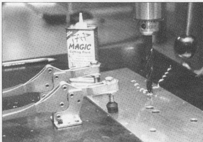
La perfección de los orificios a realizar requiere el uso de un fluido adecuado que facilite el trabajo de las brocas. Están disponibles productos especiales para toda clase de materiales. Aquí se utilizó aceite cortador para aluminio.
