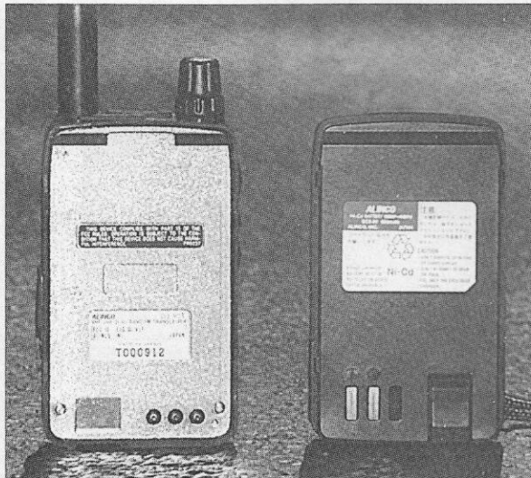
Retirando el bloque de la batería de Ni-Cd del DJ-V5 aparece el departamento blindado que aloja su «cerebro» y su músculo.
