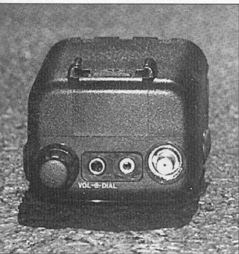
Adecuadamente encajonado entre los mandos rotativos y el conector de antena SMA, la conexión de micrófono y auricular acepta los conectores estándar dobles de micrófono (Alinco, Icom, Yaesu, Standard, Tandy) así como los de radiopaquete.
