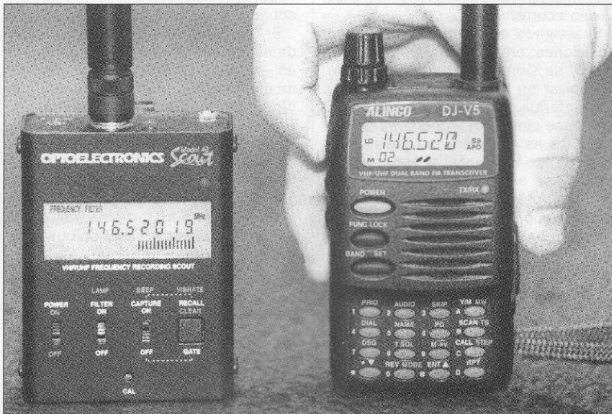
El DJ-V5 se lleva confortablemente en la mano. Una leve presión en la tecla PTT genera señal de RF, tal como se ve en el frecuencímetro.
