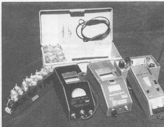
Un trio de osciladores por mínimo de rejilla: a la izquierda el Millen 90651 con sus bobinas; en el centro el Millen/Caywood 90652 con su sonda y el cable del eslabón adicional y, finalmente, el modelo Eico 710 con sus bobinas.
