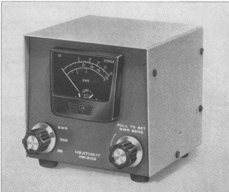
Este es el popular vatímetro y medidor de ROE Heathkit HM-2102, un hito en la producción de accesorios para radioaficionado. (Foto original de Heath Company).
