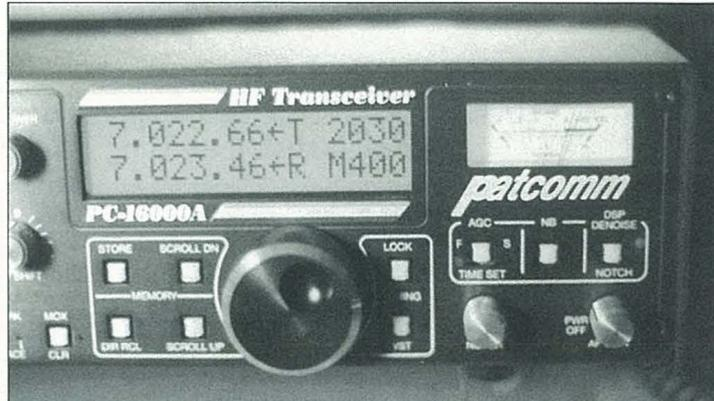
El dial de dos líneas del PC-16000A/E es de mayores dimensiones que en el PC-16000 primitivo. En las comunicaciones en «split» la frecuencia de transmisión se muestra en la primera línea y la frecuencia de recepción en la segunda línea. Las señales de CW y de RTTY decodificadas también van apareciendo en la pantalla
