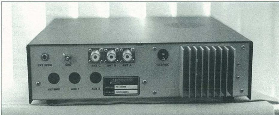
La vista posterior del equipo muestra una distribución agradable y sencilla y un refrigerador decoroso. La unidad no lleva ventilador puesto que el equipo no lo necesita. Repárese en la existencia de tres conectores de antena, que se seleccionan desde el panel frontal del aparato. El cable de conexión del teclado suministrado con el equipo se enchufa en el conector mostrado en el extremo izquierdo de la parte inferior de la fotografía.
