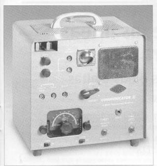
Foto 5. El Communicator II de Gonset, uno de los primeros combinados de receptor y emisor para VHF y sucesor del Communicator, añadía un silenciador y un jack de auriculares.
