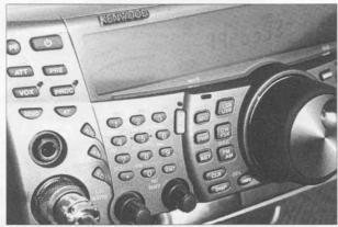
El panel frontal del TS-2000 ha sido diseñado con la facilidad de uso en mente, con los botones más utilizados agrupados alrededor del mando principal de sintonía. Los dos mandos junto al conector de micrófono permiten ajustar el filtrado DSP. (Foto de WB6NOA).
