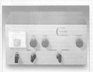
Foto 6. He aquí el transmisor Centimeg 432. Su válvula final 2C39A proporcionaba una salida de 10 W en la banda de 70 cm.
