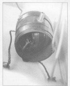
Foto 5. La posición de una bobina respecto a la otra determina la potencia de salida.
