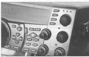
Al lado derecho del transceptor se incluyen controles para seleccionar entre los sintonizadores principal y secundario, operación en frecuencia separada, etc. El botón «Satélite» efectúa la sintonización controlada de los dos VFO, y el botón TF-SET permite escuchar la frecuencia de transmisión durante operación en frecuencia separada. (Foto de WB6NOA).
