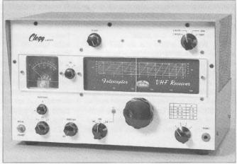
Foto 4. Un receptor para acompañar al Clegg Zeuss, el Interceptor, que recibía SSB, además de AM y CW.
