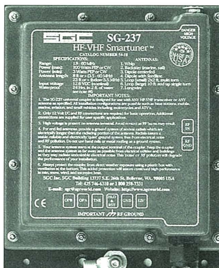
Foto A. El nuevo acoplador automático de antena SGC-237 permite trabajar desde 160 a 6 metros de manera efectiva y con «manos libres». La unidad mide 4,6 x 17,8 x 22,9 cm y funciona con un látigo para móvil de 2,13 o 2,74 m de longitud, o con numerosas configuraciones de antenas de hilo para uso en casa o portable.
