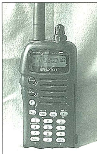
El TH-G71 opera en 2 m y 70 cm, ofrece 200 canales de memoria y puede almacenar frecuencias de servicio público y aeronáuticas. Con sus 6 W de salida, pertenece a la categoría de robustos.
