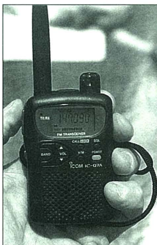
El pequeño IC-Q7A de Icom es una «cosita» llena de prestaciones, incluyendo la cobertura de recepción desde 30 a 1.300 MHz, lo cual significa que puede sintonizar las bandas de aficionado de 6 metros, 222, 902 y 1.296 MHz, además de poder operar como transceptor con una salida de 1/2 W en 2 m y 70 cm.
