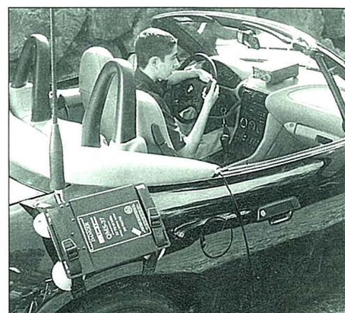
Foto B. Como se ve en este conjunto instalado sobre un deportivo BMW, el conjunto completo (SG-237, QMS-37 y SG-307) de acoplador, arnés y antena puede montarse rápidamente en casi cualquier vehículo sin necesidad de agujeros, tornillos o riesgo de estropear los acabados.
