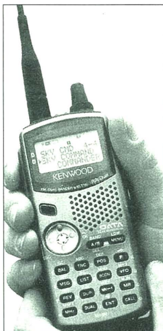
El primer portátil en incorporar un TNC para radiopaquete en 1.200 y 9.600 Bd fue el TH-D7A de Kenwood, dotado además de software para transmitir datos de APRS (Automatic Position Reporting System) y que es compatible con el sistema Sky Commander para control remoto de algunos transceptores de HF.
