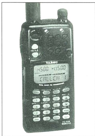
El FT-51R de Yaesu es un ejemplo típico de los portátiles de la clase «Rambo»: una sólida salida de 5 W, operación en dos bandas (2 m y 70 cm) recepción entre 76 y 999 MHz, más de 200 posiciones de memoria y una atronadora salida de audio de 0,75 W en su altavoz incorporado.
