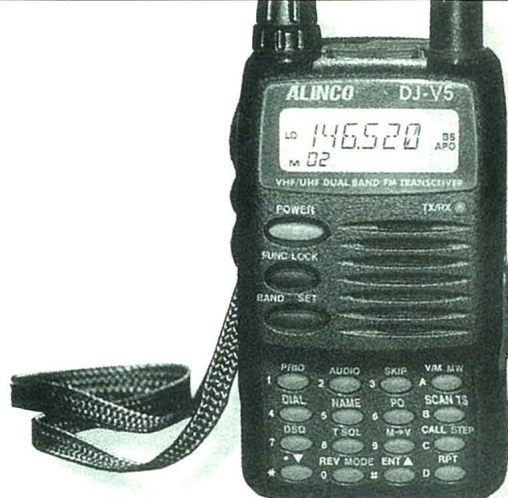
El DJ-V5 de Alinco es muy bonito, pero también muy funcional. Transmite en 2 m y 70 cm. Con una saludable salida de 5 W puede ser clasificado casi como un equipo tipo «Rambo».
