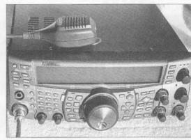
El transceptor multimodo para base o móvil para HF/ VHF/UHF TS-2000 de Kenwood puede ser pedido con el módulo opcional para 1.240-1.300 MHz instalado de fábrica y designado entonces como TS-2000X.
