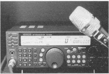
Foto A. Como este TS-570 de Kenwood, la mayoría de los modernos transceptores incluyen alguna forma de ecualización seleccionable por menú que permite adaptar la respuesta de audio al micrófono y la voz del operador.
