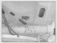
Un imán sostiene un tornillo de palomilla y la llave Allen necesarios para fijar los látigos de la antena. Adviértanse las longitudes de los látigos, escritas sobre el tubo.
