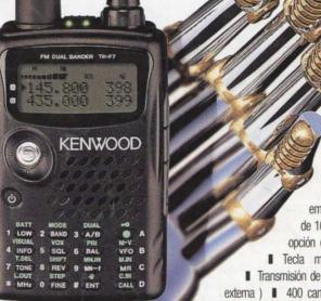
simultáneamente incluso en la misma banda. Il 0.1 - 1300 MHz en Rx (banda B) Il Modos FWFM - W/FM - N/AM - SSB/CW en recepción Il Antena de ferrita interna para recibir emisoras de radiodifusión en AM II Teclado de 16 botones para marcación manual o con opción de hasta 10 marcaciones memorizadas
