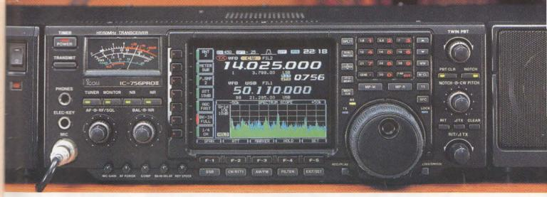
**DSP** La unidad DSP de 32 bit y coma flotante y el convertidor AD/DA a 24 bit permiten al usuario crear filtros personalizados a su estilo de tráfico y a las condiciones de la banda. Sus características de filtraje agudo y suave garantizan selectividad, limpieza y fidelidad en la reproducción de la señal.
