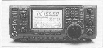
Icom ha mejorado el IC-746 con el IC-746PRO añadiéndole un DSP de 32 bit, supresor de parásitos de nivel variable, sintonía síncrona SSB/CW, filtros digitales seleccionables en FI, filtro de ranura automático e incluso un demodulador y descodificador de RTTY.
