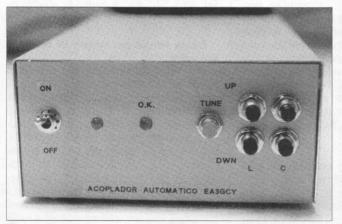
Foto A. Aspecto frontal del prototipo. La rotulación está hecha con «dymo», aunque el montaje bien merece un trabajo de serigrafía más perfeccionado. No obstante, tiene todas las indicaciones necesarias para que su manejo sea perfectamente intelegible.
