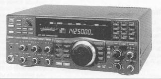
El JST-245 de JRC es un potente transceptor, de por lo menos 200 W de salida que cubre la HF más los 6 metros y tiene un receptor de triple conversión y un audio de gran sonido.
