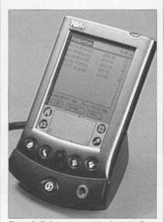
Figura 3. El Palm dentro del módulo HotSync. Este módulo se utiliza para transferir datos entre el ordenador y el Palm, a través de su puerto RS-232. En la pantalla se muestra una tabla con los pases de la estación espacial internacional sobre mi QTH durante el mes de marzo de 2002, tabla calculada por PocketSat.
