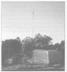
El dipolo en V invertida para 1,8 MHz de VK6VZ, a 27 m de altura, está sostenido por un mástil de extensión en aluminio y fibra de vidrio y montado sobre una Yagi tribanda reconstruida, de Wilson System.
