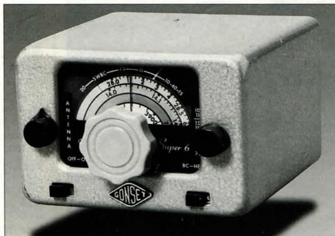
El Super 6 de Gonset, que podía montarse tanto en la columna de la dirección como instalarlo sobre el salpicadero. Los conversores Gonset fueron un hito en las primeras operaciones en móvil.
