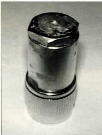
Carga artificial de prueba dentro del conector N (50 Ω). Obsérvese el tapón de cobre soldado a la tuerca.
