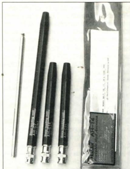
Foto 1. Las nuevas miniantenas de HF de la firma Maldol utilizan una sección desplegable y bobinas intercambiables para la base para cubrir los 40, 20, 15 y 10 metros. Para operar, se extienden hasta aproximadamente 127 cm y para transportarlas se repliega la sección telescópica y se separa de la bobina quedando el conjunto en dos secciones de unos 18 cm cada una. Las bobinas y la sección telescópica pueden comprarse por separado para ajustarse a sus necesidades.
