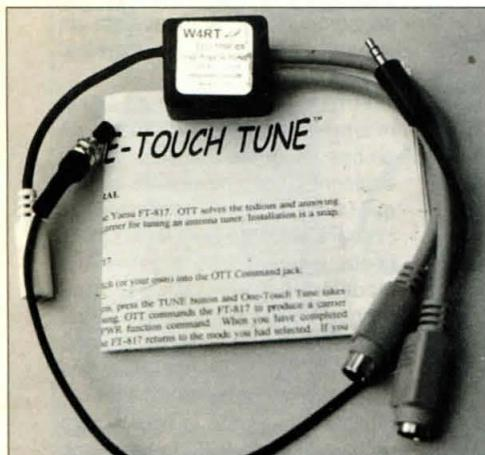
Foto 9. El nuevo sistema de acoplamiento con un solo botón de W4RT Electronics. La unidad se enchufa en los conectores de la parte posterior del FT-817 y apretando el botón o bien mediante la activación remota desde el acoplador LDG Z-11, activa el equipo para que transmita una portadora para acoplar.
