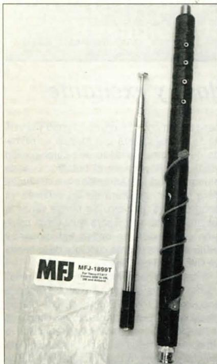
Foto 3. Todas las bandas al alcance de su mano, la nueva antena Walkabout MFJ-1899T cubre desde 80 a 2 metros en un paquete desmontable y transportable a cualquier parte. Totalmente extendida mide 160 cm. Replegada y desmontada, la parte telescópica mide unos 18 cm y la bobina de la base unos 30 cm.
