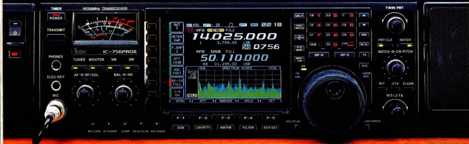
**DSP** La unidad DSP de 32 bit y coma flotante y el convertidor AD/DA a 24 bit permiten al usuario crear filtros personalizados a su estilo de tráfico y a las condiciones de la banda. Sus características de filtraje agudo y suave garantizan selectividad, limpieza y fidelidad en la reproducción de la señal.
