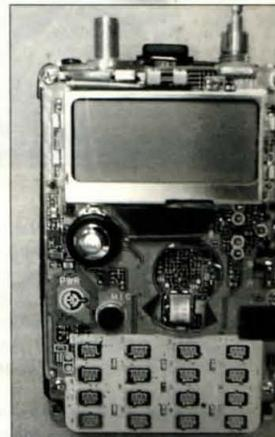
Foto 3. La unidad de control constituye un bloque separado que reúne el teclado, el mando táctil multifuncional y la pantalla.
