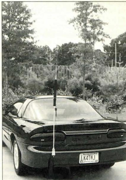
Foto 6. La versión más alta de la super antena de W6MMA para móvil está configurada con un mástil de base de unos 56 cm, la bobina motorizada de 36 cm, y la varilla superior de 122 cm. La antena puede configurarse como más larga o corta, en función de los mástiles y varillas opcionales colocados.
