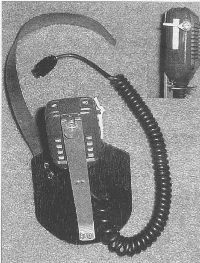
Soporte de micrófono «manos libres» tipo casero de W6BNB. El detalle de la esquina superior muestra cómo se ha resuelto la pieza que mantiene la tecla PTT en posición de transmisión.
