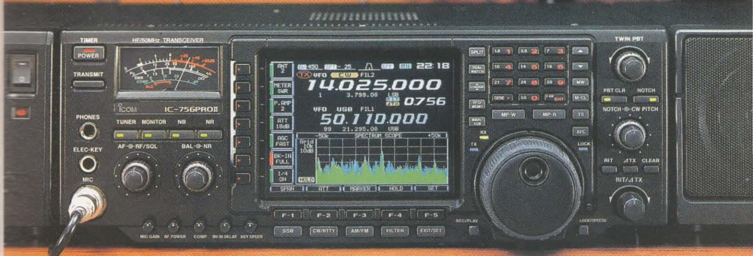
**DSP** La unidad DSP de 32 bit y coma flotante y el convertidor AD/DA a 24 bit permiten al usuario crear filtros personalizados a su estilo de tráfico y a las condiciones de la banda. Sus características de filtraje agudo y suave garantizan selectividad, limpieza y fidelidad en la reproducción de la señal.
