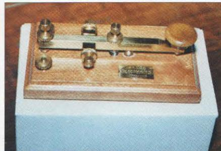
Foto 9. Un manipulador clásico y de amplia aceptación: el modelo GME.
