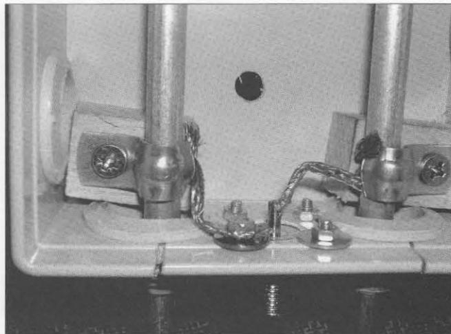
Foto 8. Detalle de la conexión entre el conector SO-239 y los tubos de aluminio. Se usaron cortos trozos de malla, arrollados sobre los tubos debajo de las bridas de sujeción. Una soldada al vivo y la otra estáñada y fijada debajo de una tuerca del conector.
