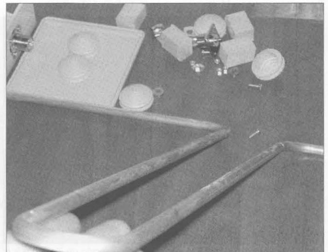
Foto 5. Vista de los giros efectuados en el tubo. En primer plano, el giro de 180° que forma el «stub» o sección adaptadora y más allá los dos de 90° para cada uno de los elementos que componen la colineal.
