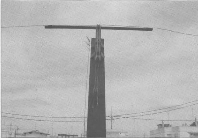
Foto 3. Antena colineal de alambre preparada para operar en polarización horizontal. Su aspecto no es muy robusto pero, ¿quién puede dar más por menos?
