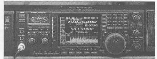
y entre las mejoras anunciadas están el nuevo filtrado de entrada de cuatro secciones (que mejora aún más la resistencia del receptor frente a señales adyacentes de elevado nivel), la posibilidad de selección de la forma de los filtros de FI y una apreciable reducción del ruido de fondo (visible en forma de «hierba» en la pantalla del analizador). La sensibilidad en SSB o CW sigue siendo tan elevada que hace prácticamente innecesario el uso del preamplificador.
