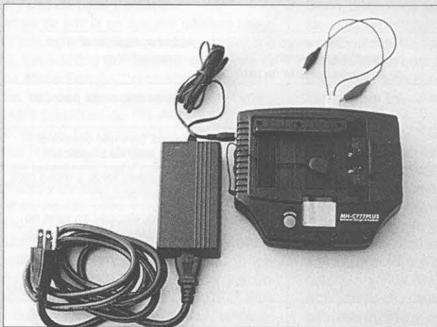
Foto 4. El cargador de la firma Maha modelo MHC777 Plus está controlado por un microprocesador, posee contactos corredizos para acoplarse a diferentes tipos de baterías, una base magnética para hacer que la batería permanezca en su sitio y un sensor de temperatura. ¡Realmente elaborado!
