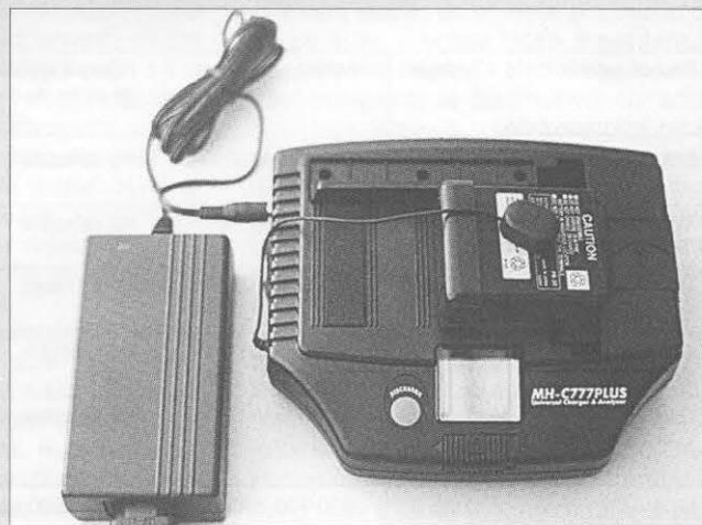
Foto 5. El Maha MHC777 Plus, con sus contactos deslizantes y el sensor de temperatura en su lugar de trabajo (sobre la batería) está cargando un pack PB-22 Kenwood. Nótese que el uso de los contactos superiores del pack permite una carga rápida en paquetes de NiCd y/o carcasa de baterías compuestas por pilas tipo NiMH.
