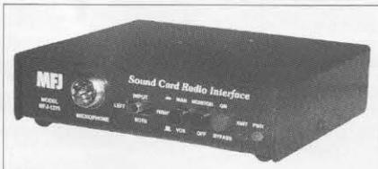
mente, permite seguir utilizando el micrófono del equipo y trabajar con él sin necesidad de manipulaciones de cables o conectores. Una de sus más interesantes características es que con el aparato viene todo: *software*, cables de audio y conector de alimentación. Y viene en dos versiones: la MFJ-1275 para conectores de micrófono redondos y la 1275M, para conectores modulares.
