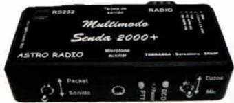
**MÓDEM PACKET-RADIO + Adaptador tarjeta de sonido**
