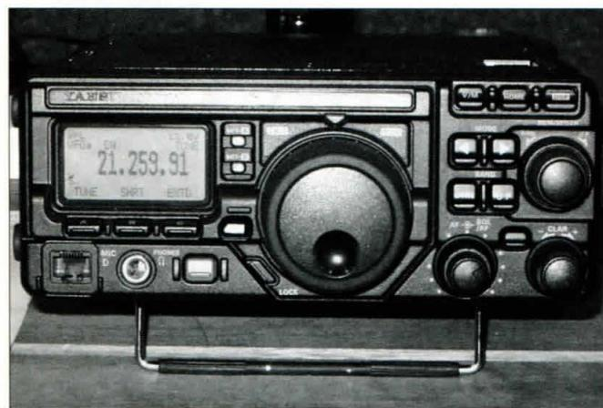
El nuevo FT-897 de Yaesu, variante del popular 817, fue uno de los hits de la muestra. Saca hasta 100 W cuando se le conecta a una fuente convencional, o 20 W con su batería de NiMH interna. La radio cubre desde 160 metros hasta 70 centímetros.
