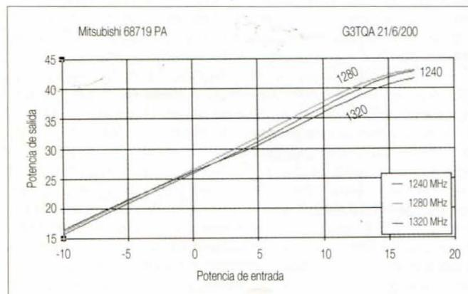
Figura 3. Gráfica de la relación de potencias entrada/salida (en dBm) del módulo híbrido Mitubishi 68719 PA.
