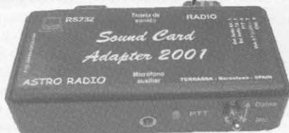
Adaptador de tarjeta de sonido, compatible con la gran mayoría de los modernos programas para comunicaciones digitales Especialmente indicado para su uso en HF, para evitar realimentaciones y retornos de tierra, las señales de audio y PTT están totalmente aisladas, incluye 2 transformadores de audio independientes, niveles TX y RX ajustables y opto-acoplador.
