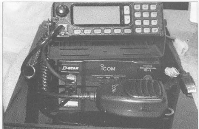
Foto A. Transceptor ID-1 de Icom que opera en 1.296 MHz en sistema digital D-Star.
