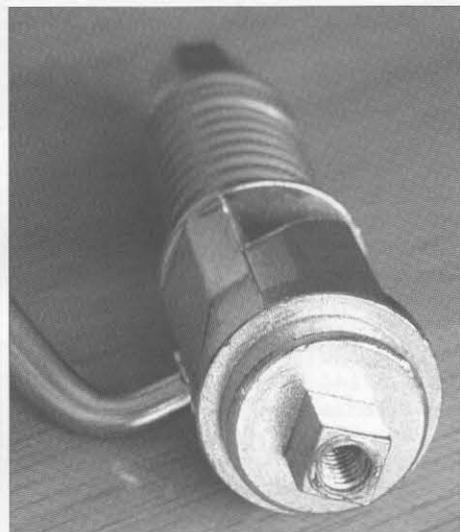
Foto 2. Parte inferior de la base del portaantenas, mostrando la zona donde se deberán adaptar las piezas que constituirán el conector tipo PL-259.
