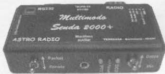
**MÓDEM PACKET-RADIO + Adaptador tarjeta de sonido**
