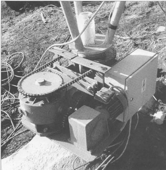
El sistema de giro de la torre hace uso de un mecanismo con engranaje sinfín y accionado por cadena. La caja contiene la electrónica que proporciona un arranque y frenada suaves.
