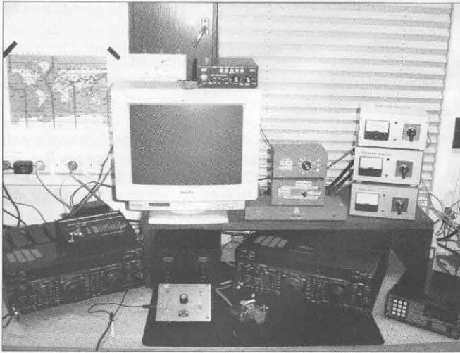
La estación de concursos incluye un par de transceptores FT-1000MP MarkV de Yaesu, conectados a un controlador SO2R de WX0B. Las torres sostienen numerosas antenas y su conmutación está controlada por los descodificadores de banda. Un PC bajo TR Log lo controla todo, de forma que los cambios de banda se efectúan instantáneamente a través del teclado. La estación OH2BH está montada para la máxima eficacia en concursos. (Foto de Toni, OH2JTE).
