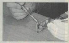
Postura adoptada para desoldar los transistores del LNB.
