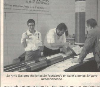
www-eh-antenna.com/>, se basa en un concepto distinto: se trata de forzar un desfase en la corriente que circula por el radiador de modo que ambos campos, eléctrico y magnético estén ya enfasados en las inmediaciones de la antena. Para ello, el diseño mecánico de este tipo de antenas es completamente distinto de las Hertz, con unas dimensiones muy inferiores (del orden de 1/20 de longitud de onda). En principio, las antenas EH se usaron para la recepción de señales de Onda Media, pero
