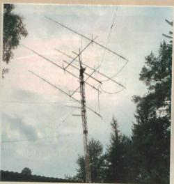
Antena de 4x15 elementos y doble polarización con la que RU1AA domina la modalidad de rebote lunar.
