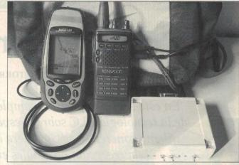
Foto C. Una instalación portable de APRS. La información de posición procedente del receptor GPS, codificada por el PicM, se difunde como señal APRS a través de un transceptor portátil.
