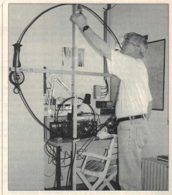
Foto A. Prototipo de la versión A, con sintonía manual usando un condensador variable de aire de 2x410 pF, del tipo usado en receptores superheterodinos antiguos.
