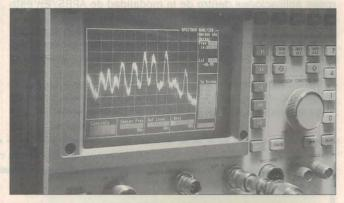
Foto A. Grafica de señal PLC en la pantalla del analizador de espectro
