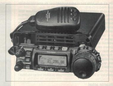
El FT-857 de Yaesu incorpora un analizador de espectro para monitorizar la actividad en la banda, sistema de búsqueda inteligente «Smart Search» y comprobador de cobertura ARTS, así como elementos opcionales, como DSP multifunción, con filtro pasabanda y de ranura, reductor de ruido y ecualizador de micrófono.
