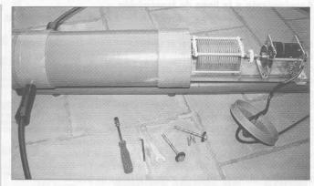
Foto B.- Detalle del conjunto de sintonía de la antena de aro para 80 metros. Vista en un primer plano del condensador variable de 488 pF / 2000 V cuyo rotor está unido mecánicamente por un separador axial, y aislante de la RF con el motor-reductor.
