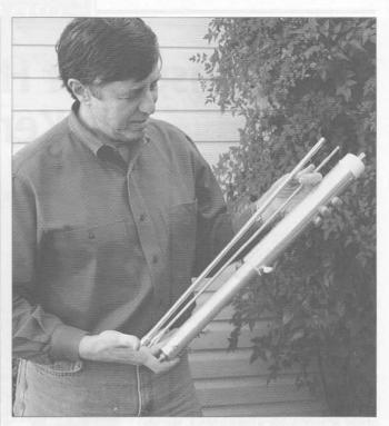
Foto 3. El autor sosteniendo la antena MFJ-1664 desmontada, incluidos los tramos del látigo. La facilidad de montaje y desmontaje la hace conveniente para operación en portable (fotos cortesía del autor).
