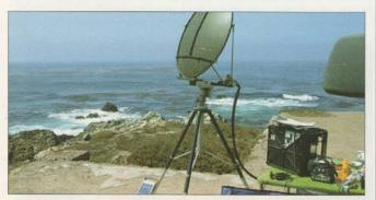
Foto E. Las actividades de microondas suponen, casi ineludiblemente, operar al aire libre. En la foto, la instalación de XE2/N6XQ y XE2ED durante un concurso en la Baja California (DM11). La parábola de 76 cm es una unidad de "surplus" y la caja de la derecha contiene un transversor DB6NT y un amplificador Qualcom de 1 W. (Foto cortesía de la SBMS)
