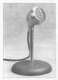
Foto 9. La primera reencarnación del famoso micrófono Astatic J-30 fue este Shure 440. Los cantantes y tocadores de armónica le desenroscaban el pie y lo mantenían en la mano; luego Shure le añadió un control de volumen en su base y lo denominó modelo 520DX. (Foto cortesía de W2CQ y fotografiado por VE3NGW)
