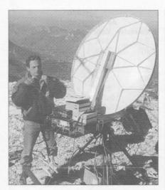
F6BVA con su impresionante estación portable de 10 GHz. Parábola de 1,2 m y 14 W.
