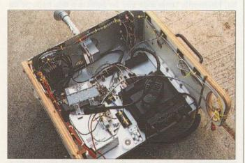
Foto B. Este es el aspecto interno que presenta actualmente Morpheus. El chasis rebatible permite un fácil acceso a los distintos módulos. El preamplificador del receptor (módulo gris en el centro izquierda) formó parte de un receptor de radar F-15 de Eagle. El transversor DEMI, de 10 GHz, está en la esquina inferior izquierda y el transceptor de la Fl de UHF es un FT-817.
