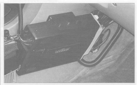
El cuerpo de la radio, montado en el compartimiento del pasajero. Véase que el cable del micrófono se conecta a la caja de la radio, no al panel de control. Si se desea montar el cuerpo de la radio en el maletero, se precisa el kit de extensión PG-4Z, de 4 m de largo, que facilita el empalme del micrófono hasta el interior del vehículo. (Foto N5FM).
