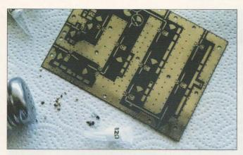
Foto C. Los componentes de montaje superficial son realmente pequeños. ¿Puede apreciar la diferencia entre un grano de pimienta y los resistores de 82 Ω? Y algunos componentes son aún más pequeños.
