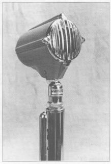
Foto 11. Parece un Astatic 10-D, y probablemente lo es, pero en su placa se lee: DuKane Model 7C40. La investigación reveló que DuKane operaba en el campo de la difusión pública y que algunos de sus productos eran simplemente de otros orígenes con una placa adicional. Esto es por lo, por ejemplo, se encuentran ElectroVoice marcados como DuKane 664. Posiblemente, el único producto genuino DuKane eran las plaquitas. (Foto cortesía de W2CQ y VE3NGW)
