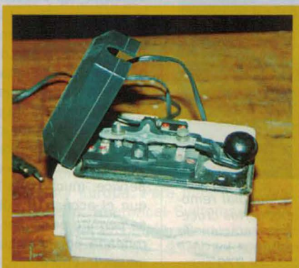
Llave de fabricación rusa y usada por el ejército de la República Popular Alemana hacia 1980. Palanca en acero galvanizado y caja de plástico. Resulta curiosa la inclinación del pomo, aparentemente anormal. En la tapa figura una inscripción en caracteres cirílicos: LDAMRHOB PA3LPAD.
