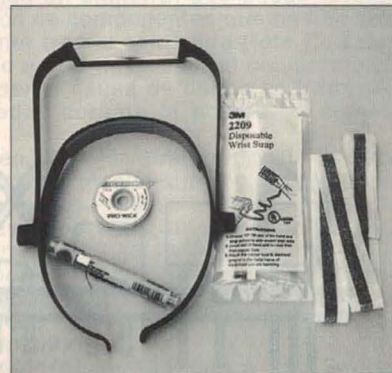
Foto B. Cosas adicionales que son una apreciable ayuda cuando se trabaja sobre placas de circuito impreso con componentes pequeños. Un rollo de hilo de estaño extrafino, un kit de "puesta a tierra" para trabajar semiconductores MOS y una lupa de visera completan la lista.
