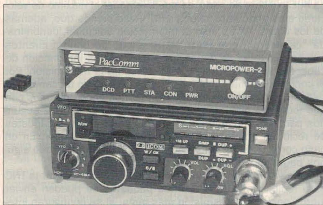
Foto 1. Una TNC Micropower de PacCom, sobre un ICOM IC-45A. Esta TNC era el "no va más" a finales de los ochenta, con su circuitería CMOS de bajo consumo y todos los integrados montados sobre zócalos. El IC-45A es un transceptor perteneciente a la primera generación de radio sintetizada, no resultando muy conveniente para un uso diario, pero perfecto para radiopaquete.
