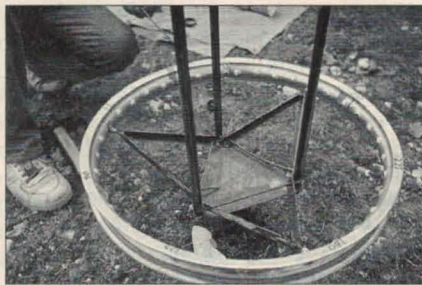
EB3GIH usa una llanta de motocicleta para hacer girar la torreta, accionada a través de una cuerda.
