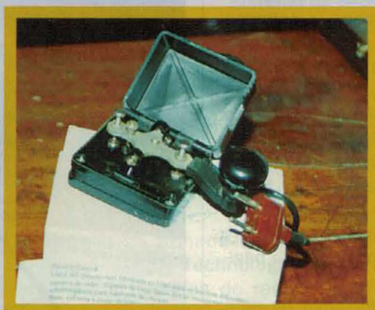
Compacto manipulador del ejército ruso, fabricado hacia 1980 para aplicarse a distintas radios de campaña, con su cable y conector originales. Algunas variantes de esta llave incluyen condensadores entre sus contactos para eliminar chispas. Pomo, cubierta y caja en plástico, montada sobre una base metálica con ranuras para fijación. Medidas: 8 x 6,5 cm.
