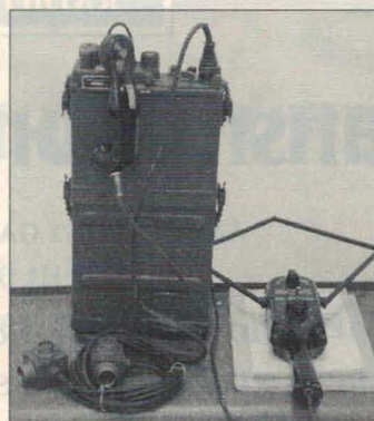
Foto E. Radioteléfono de campaña PRC-10A, fabricado por Marconi Española, y dotado de lo que al parecer es una curiosa antena de cuadro sintonizable.
