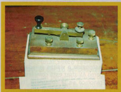
Manipulador de origen francés, usado por las estaciones PTT entre 1890 y 1920, con muelle de hoja sin regulación de tensión. Obsérvese la intuitiva disposición de los bornes, situado cada uno junto al contacto correspondiente, que no deja lugar a dudas sobre su función.
