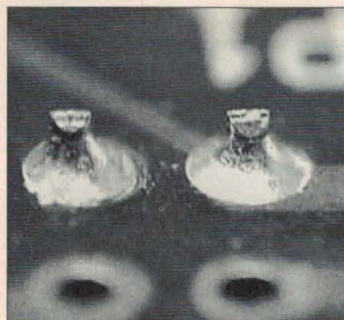
Foto C. Dos islas adyacentes y bien soldadas. El estaño fundió por el calor del soldador sobre el rabillo del componente y el cobre de la isla y se extendió por ésta formando un menisco cóncavo con el rabillo.
