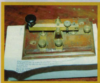
Robusta llave con brazo de latón, usada por las oficinas de Correos y Telégrafos británicas entre 1910 y 1930, de la que destacan los sólidos bornes de conexión y los contactos para alta corriente.
