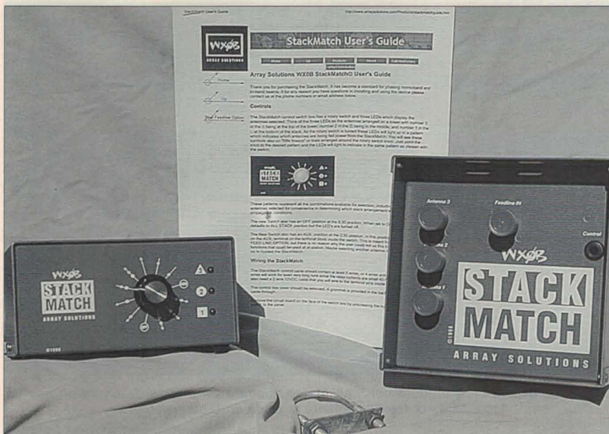
Foto A. El StackMatch de Array Solutions incluye una unidad de control que estará en el cuarto de radio (izquierda), un manual excelente (ver texto), y la unidad de conmutación (derecha) que se montará en la torre de las antenas.
