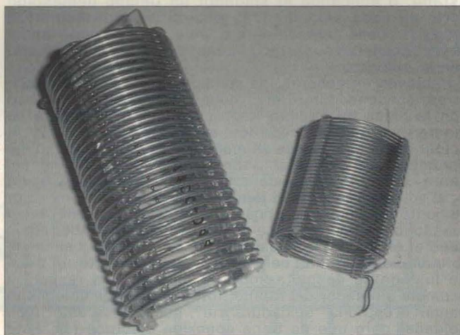
Foto A. Bobinas de alto Q (izquierda) y de bajo Q (derecha). Cuanto más grueso sea el hilo con que estén hechas, menor resistencia presentarán y mayor será el factor Q.
