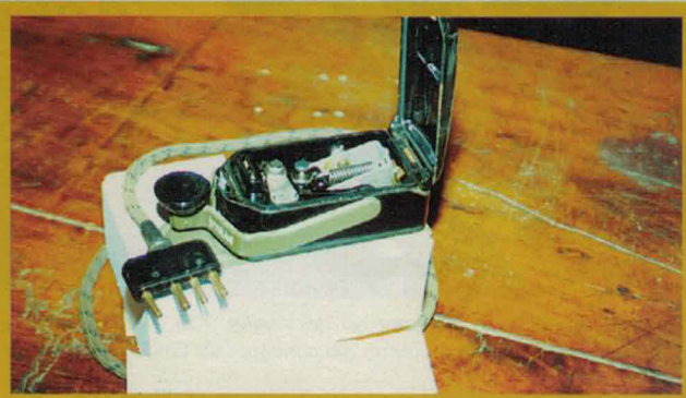
Llave utilizada por el ejército checo con diversas radios de campaña entre los años 1950 y 1970, con su cable y conector originales. Está montada sobre una base de metal y encerrada en una caja de baquelita que protege los contactos y permite ser utilizada a la intemperie. En la palanca aparecen las inscripciones "PRUEM" y "VY8ILANI". Medidas: 15 x 6,5 x 4 cm.
