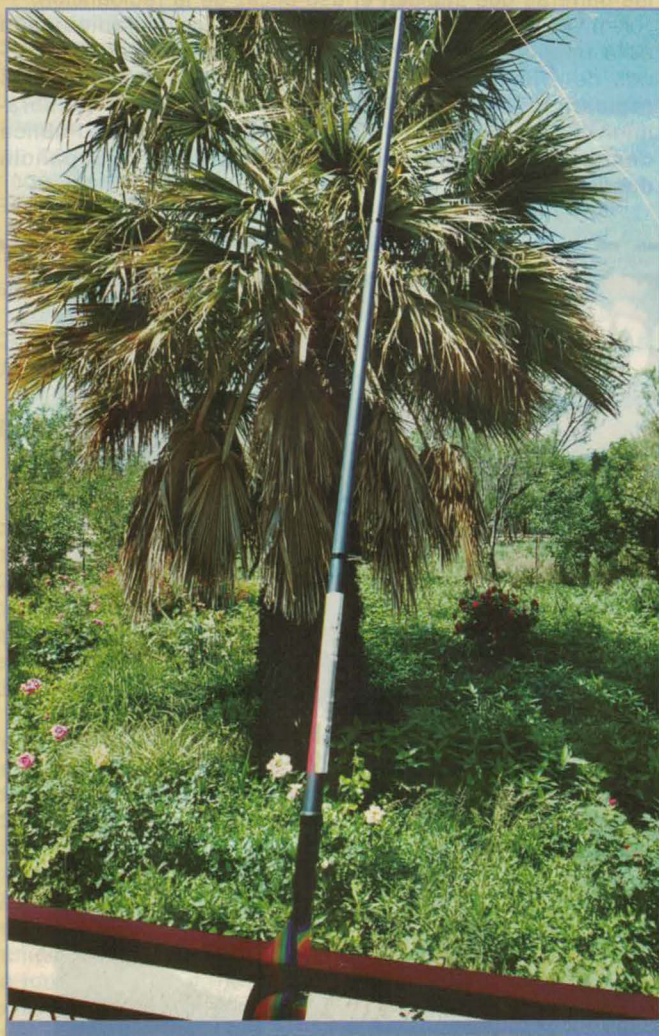
En su estancia de una semana en Skala Kalonis, el autor usó esta caña de pescar de 7 m, fijada a la barandilla del balcón para operar como SV8/SMOJHF.
