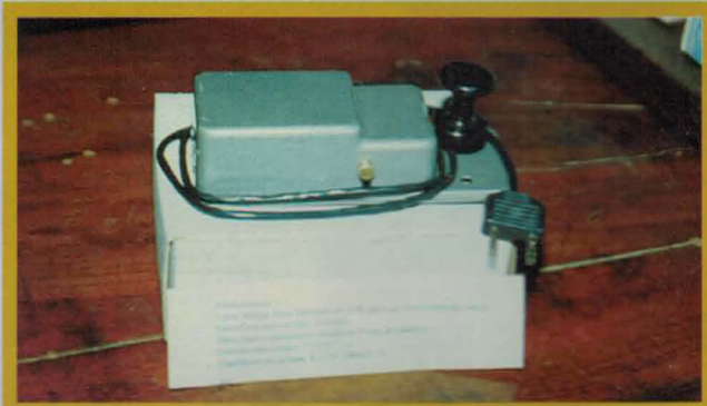
Manipulador KUM, de origen ruso, fabricado hacia 1986 para ser usado con el transmisor militar R-104M. Base y tapa metálicos y pomo de baquelita.
