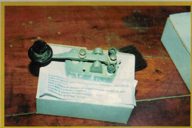
Pequeña llave francesa para uso general, fabricada hacia 1950 en aluminio inyectado y pintado, sin regulación de la tensión del muelle. En el pomo figura la inscripción "DINA". Medidas de la base: 9 x 5 cm.
