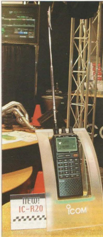
El nuevo receptor portátil IC-R20 de Icom tiene un sorprendente margen entre 150 kHz y 3.305 MHz, e incluye un grabador digital de cuatro horas.
