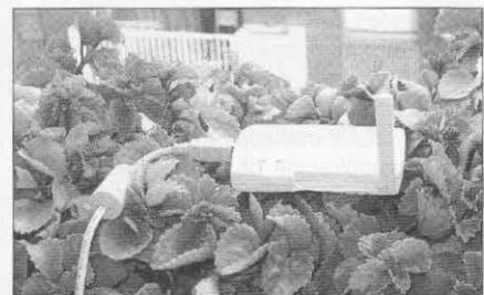
Foto 1.- Antena «balconera» de una red WLAN mallada.
