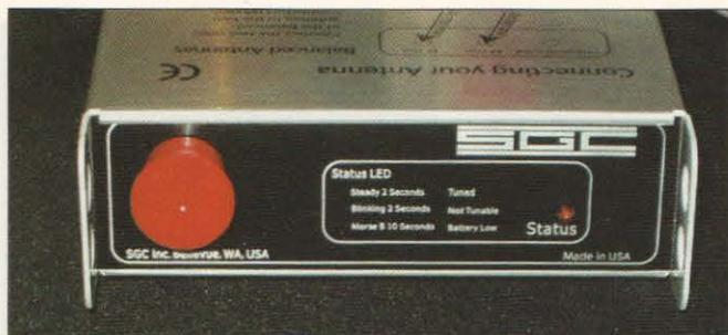
El nuevo acoplador SG-211 Mini Smartuner no tiene mandos. Detecta la frecuencia de transmisión y automáticamente sintoniza el sistema de antena para óptimo acoplamiento.
